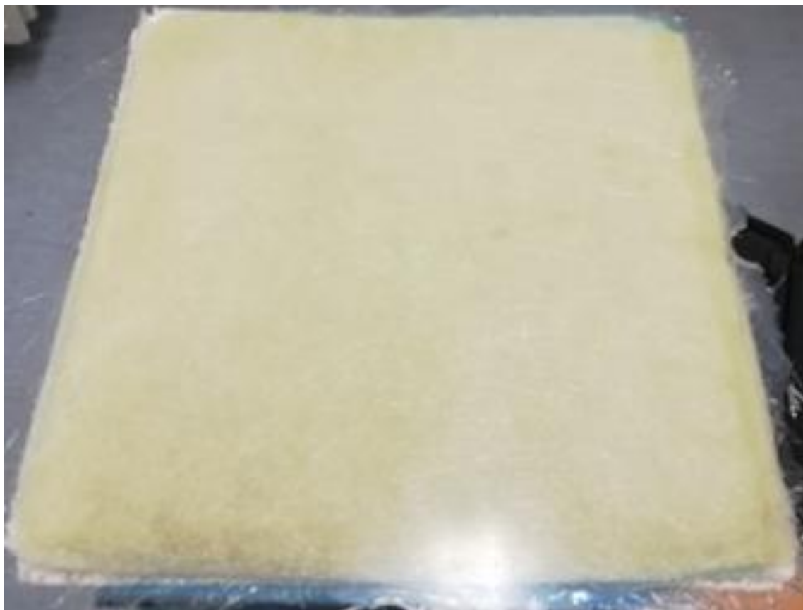
Slika 7. Izrađena polimerna kompozitna ploča ojačana mat staklenim vlaknima.
