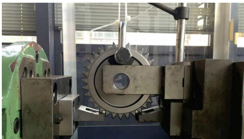
Slika 7. Ispitno postolje na pulzatoru [11]
