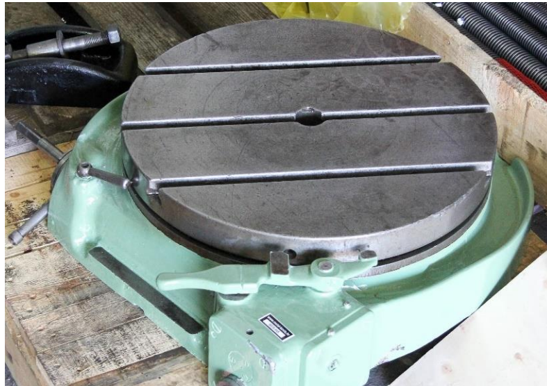
Slika 17. Vertikalna izvedba okretnog stola [12]
