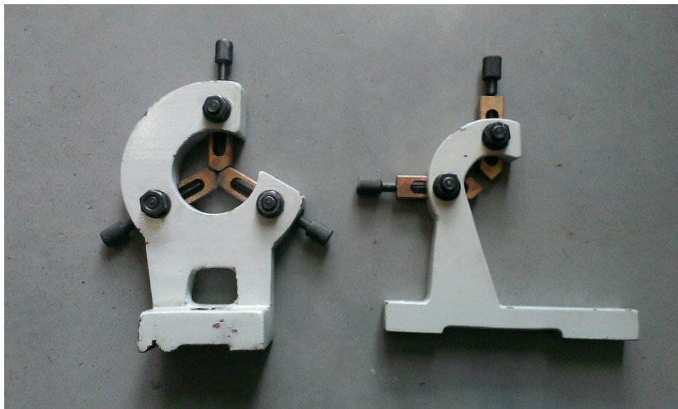
Slika 7. Prikaz stabilne i pomične linete [10]
