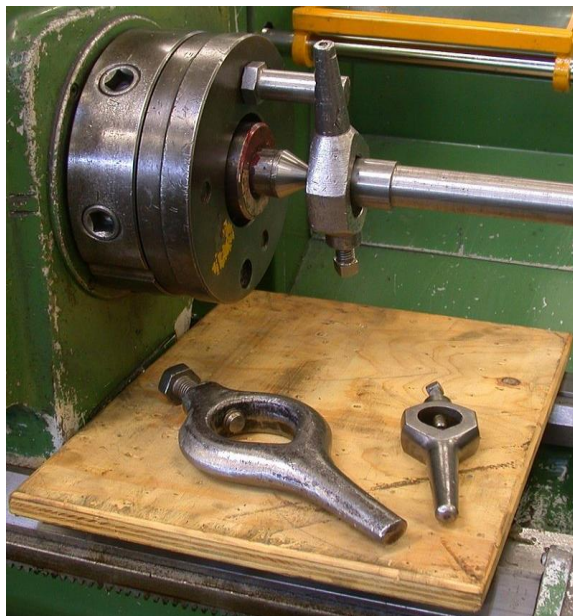
Slika 10. Prikaz tokarskog srca na alatnom stroju [11]
