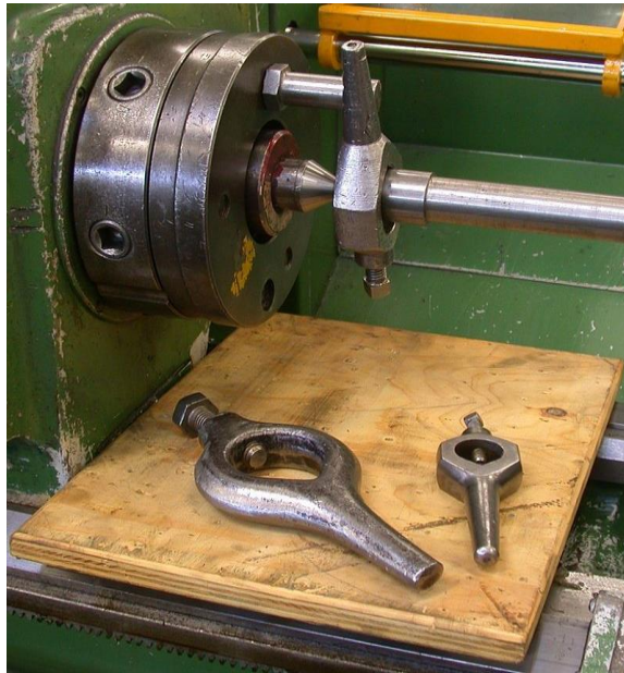
Slika 10. Prikaz tokarskog srca na alatnom stroju [11]
