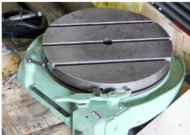
Slika 17. Vertikalna izvedba okretnog stola [12]
