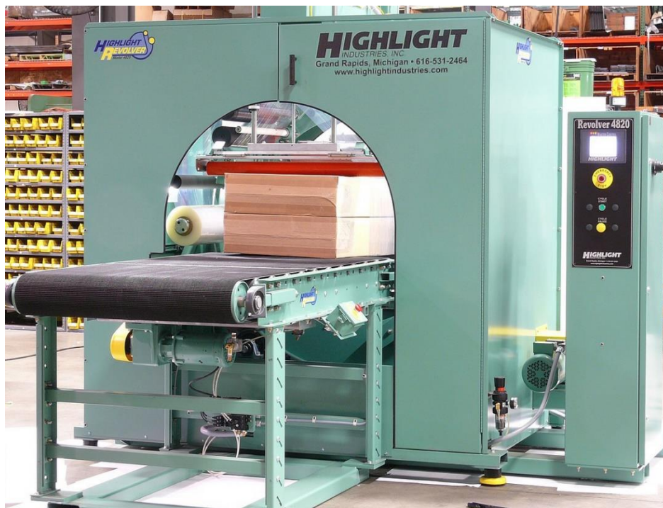
Slika 7. Uređaj sa vertikalnim rotacijskim prstenom
