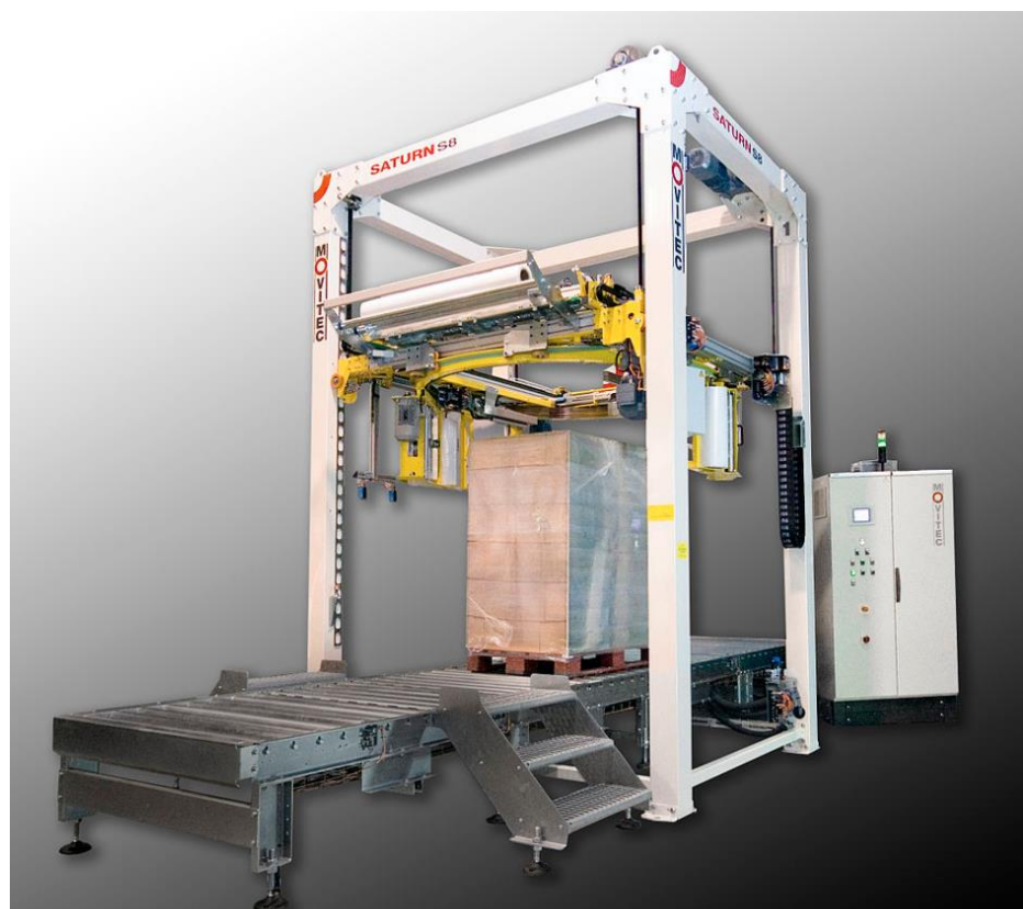
Slika 8. Uređaj sa horizontalnim rotacijskim prstenom
