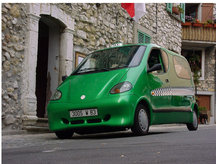
Slika 1.1 Primjer hibridnog motornog vozila sa pneumatskim pogonom [2]
