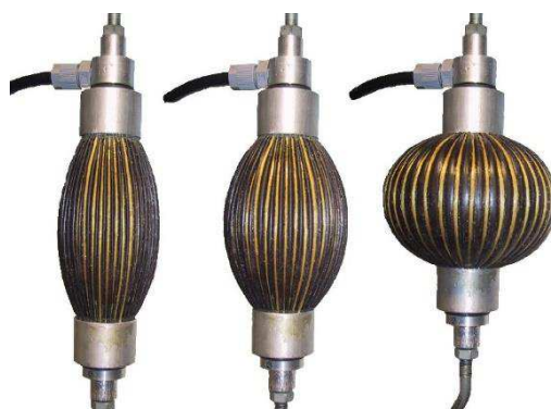
Slika 4.3 Pneumatski mišić s uzdužnom armaturom [17]
