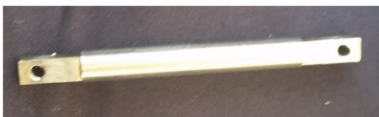
Slika 3.9 Izrađen rukavac koljenastog vratila
