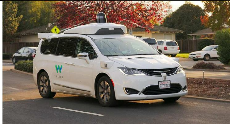
Slika 2.4 Primjer autonomnog vozila proizvođača Chrysler [6]
