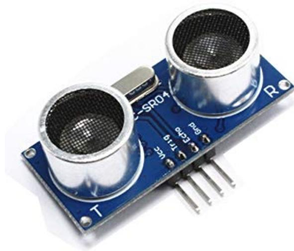
**Slika 5.3 Ultrazvučni senzor HC-SR04**
