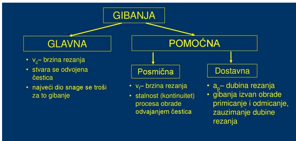
Slika 25. Gibanja kod obrade odvajanjem čestica [8]
