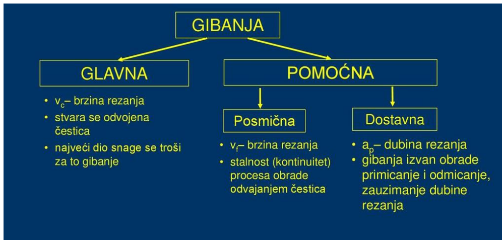
Slika 25. Gibanja kod obrade odvajanjem čestica [8]
