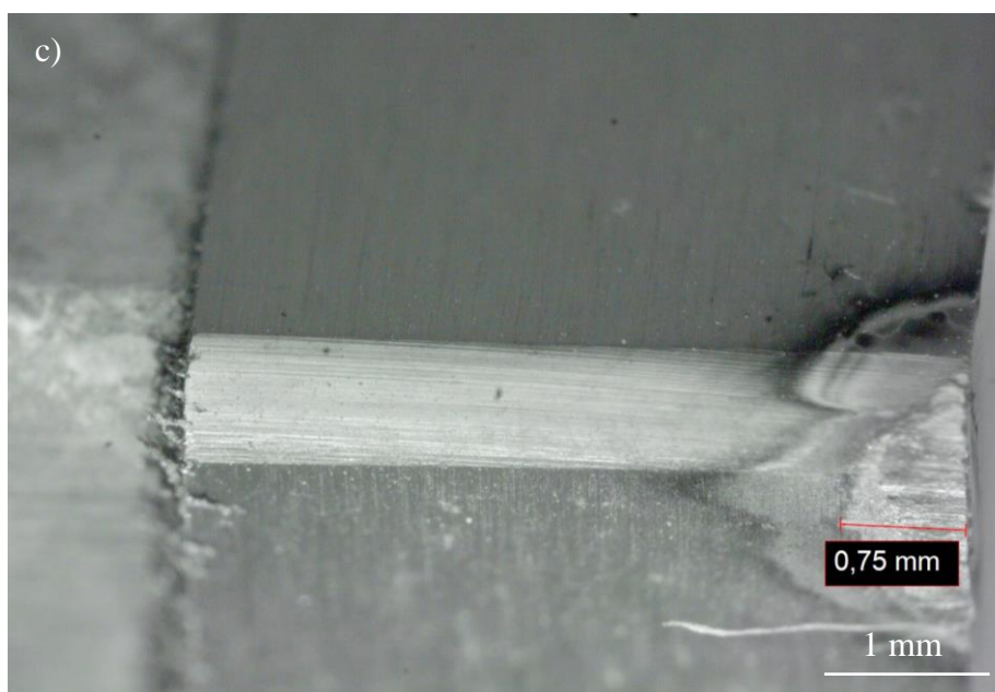
Slika 43. Trošenje stražnje površine rezne pločice:
