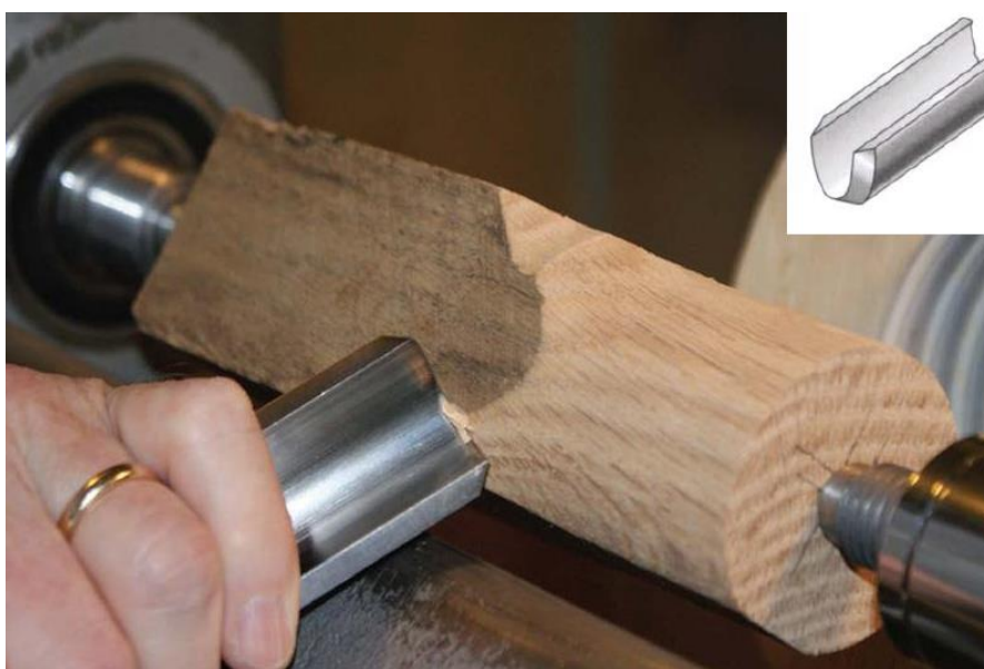
Slika 25. Tokarski alat za poravnavanje u zahvatu [19]
