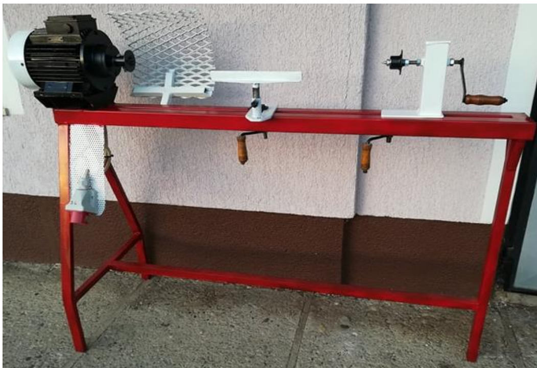
Slika 32. Prototip modelarske tokarilice
