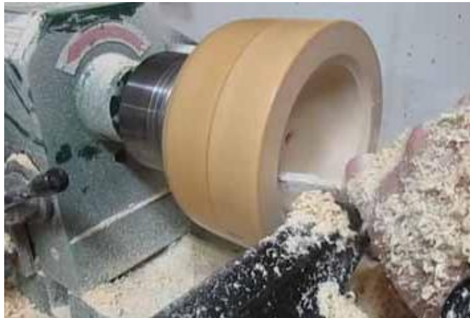
Slika 16. Poprečno unutarnje tokarenje [13]
