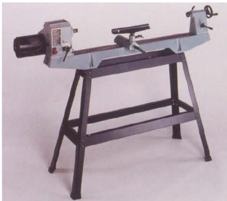
Slika 29. Primjer modelarske tokarilice, DELTA 47-700 [20]
