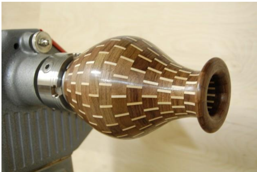
Slika 23. Sjajna i glatka površina poliranog obratka [17]
