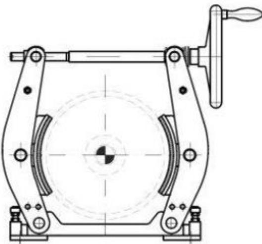
Slika 13. Mehanizam dvočeljusne bubanjske kočnice sa vretenom [8]
