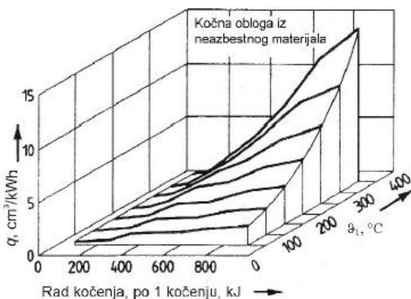
Slika 20. Ovisnost koeficijenta trošenja o radnoj temperaturi  $g_1$  i radu kočenja [6]
