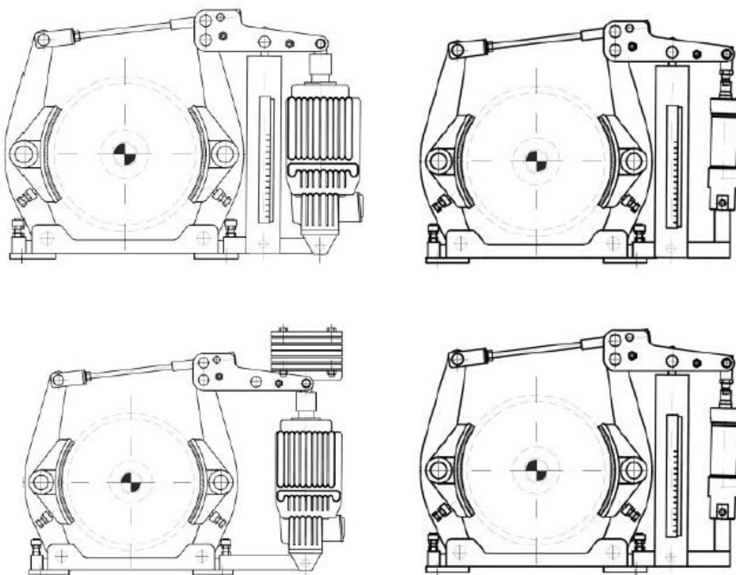
Slika 10. Elektrohidraulički (lijevo) i hidraulički (desno) aktivirane kočnice [8]
