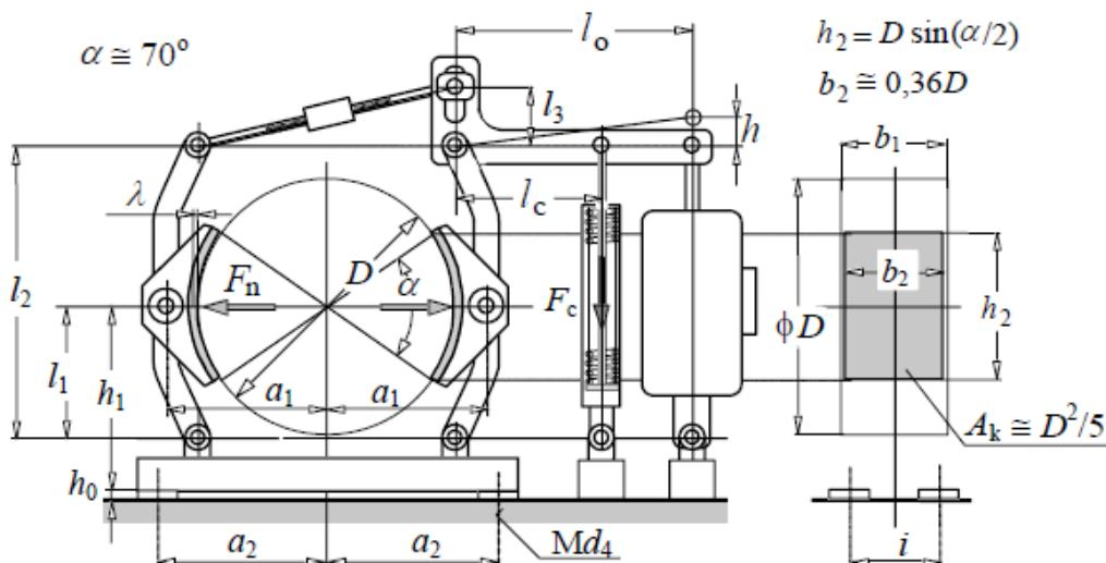
**Slika 12. Ugradbene mjere bubenjske kočnice [6]**
