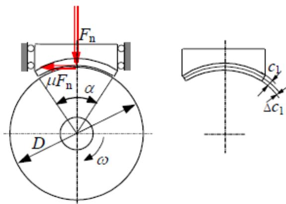
Slika 19. Trošenje obloge [6]
