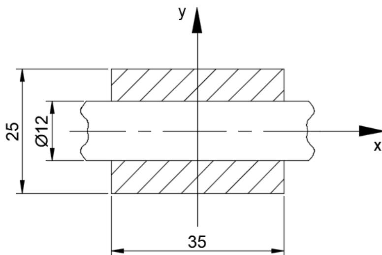
Slika 16. Presjek zgloba
