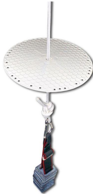
Slika 2. „Bottom plate“ sa utegom
