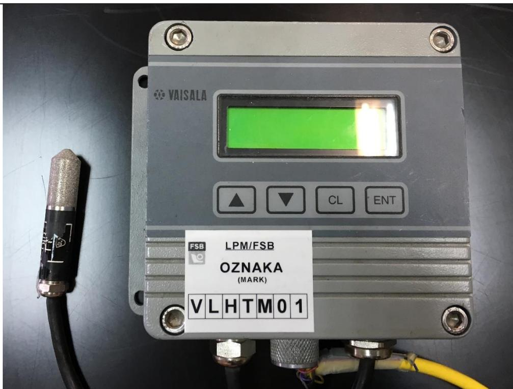
Slika 17. Termometar i higrometar
