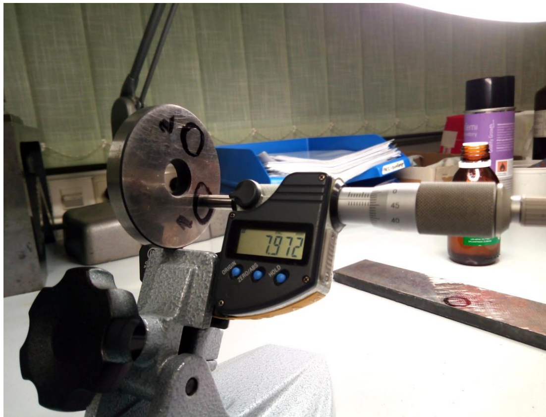
Slika 33. Mjerenje debljine etalonske pločice tvrdoće digitalnim vanjskim mikrometrom MV 28-454
