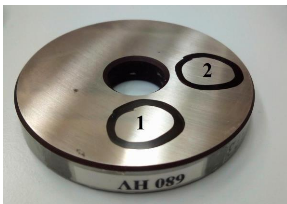
Slika 31. Mjesta mjerenja na etalonskoj pločici tvrdoće 680HV (jednaka kao i na ostalim etalonskim pločicama tvrdoće)
