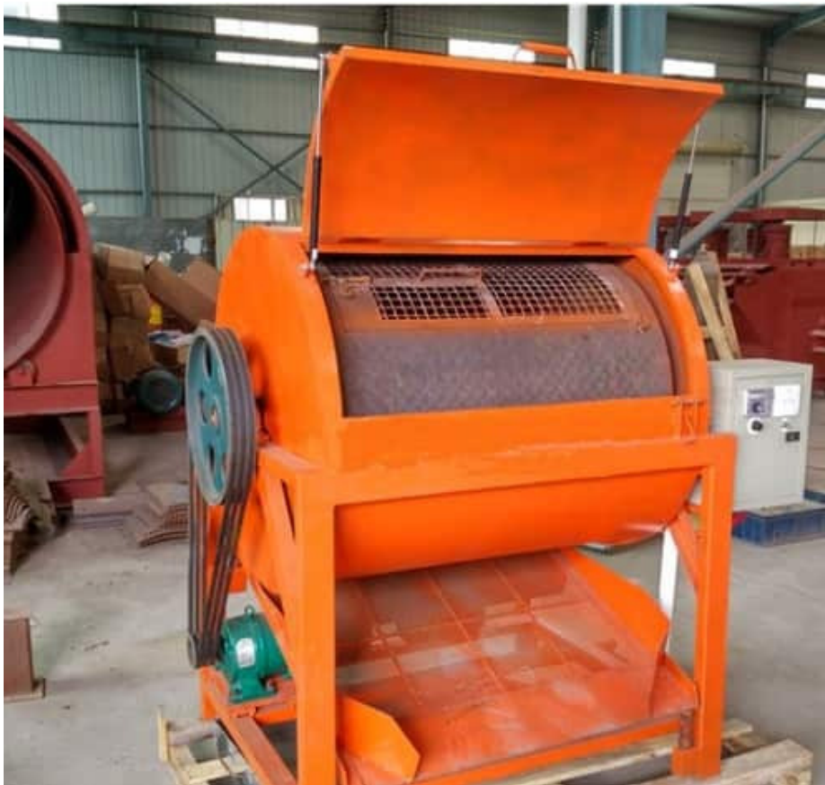
slika 6. Bujanj za odvajanje komponenti sa matičnih ploča
