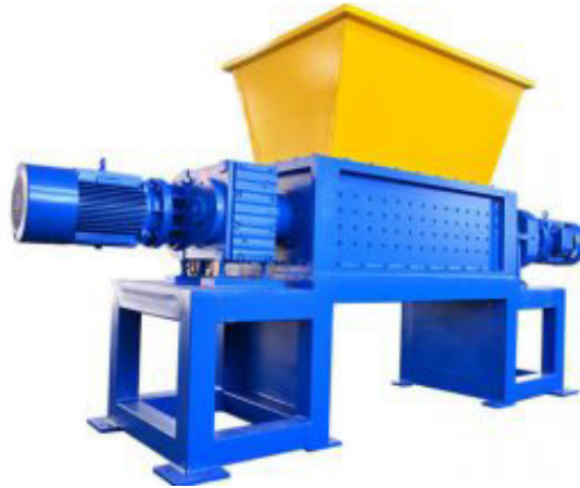
slika 8. Drobilica za štampane ploče
