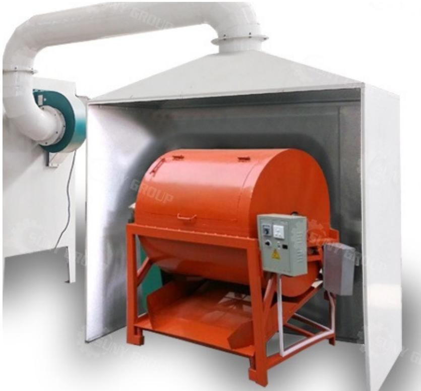
**slika 7. Sustav za filtraciju štetnih plinova**
