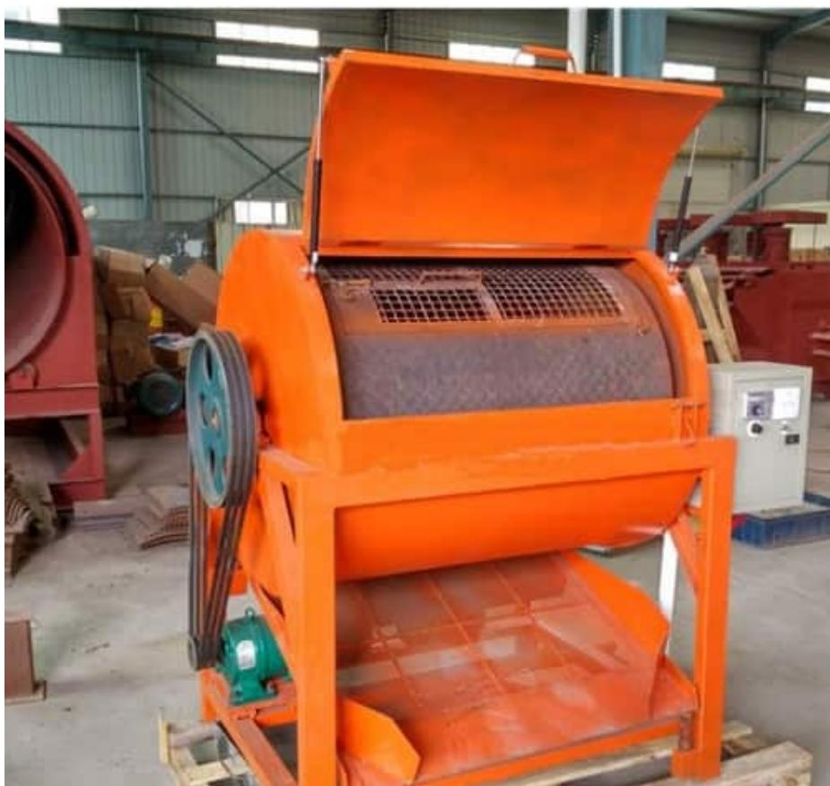
slika 6. Bubanj za odvajanje komponenti sa matičnih ploča
