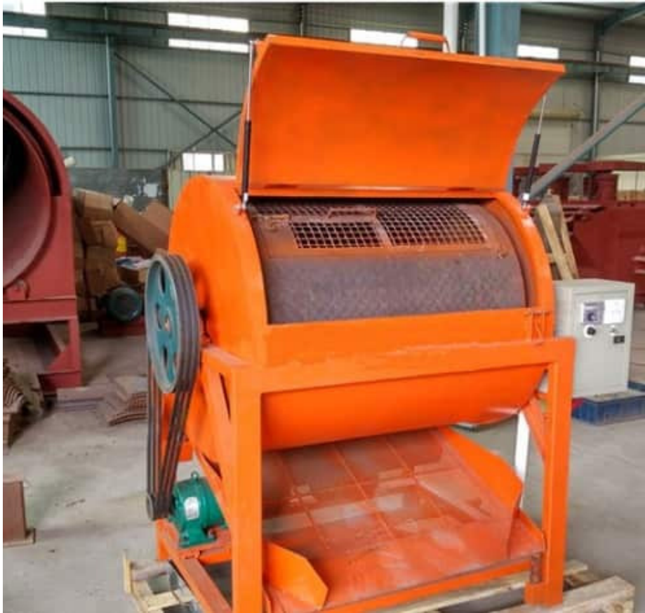
slika 6. Bujanj za odvajanje komponenti sa matičnih ploča
