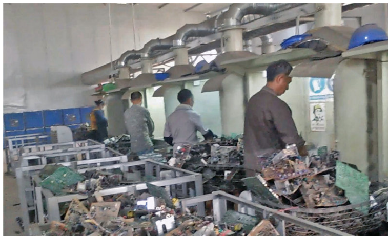
slika 4. Ručno rastavljanje štampanih ploča
