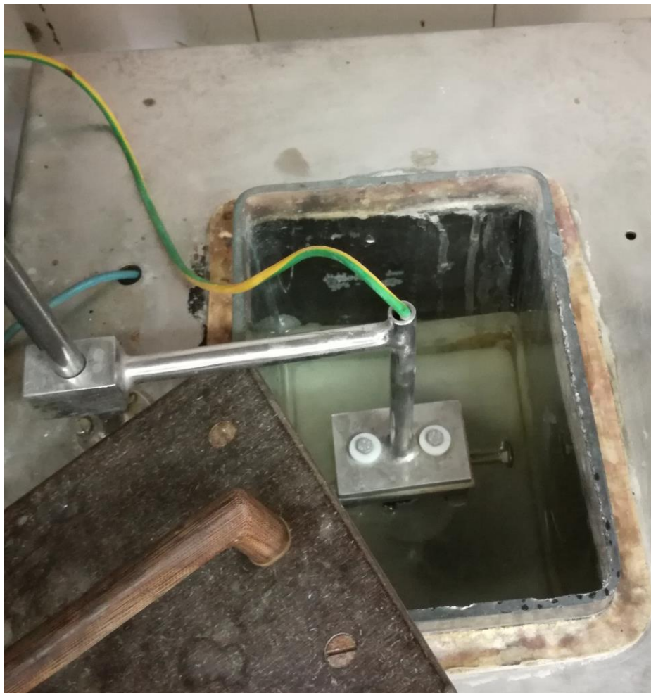
Slika 22. Komora za elektrokemijsko nagrivanje uzoraka
