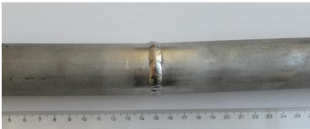
Slika 10. Zavarena cijev od super dupleks čelika
