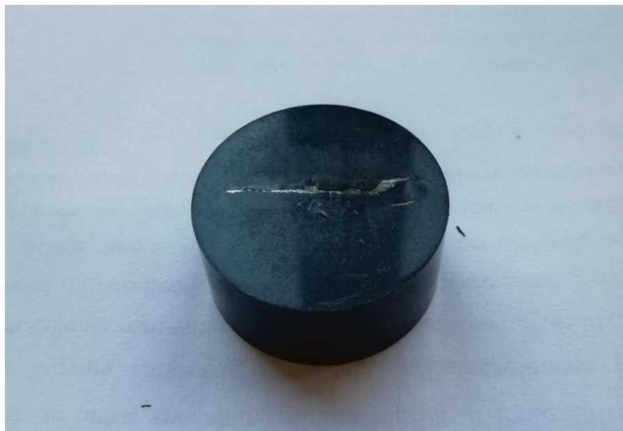
Slika 19. Metalografski uzorak nakon zalijevanja u polimernu masu
