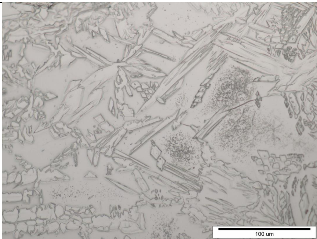
Slika 37. Mikrostruktura u tjemenu ZUT-a lijevo, snimljena pri povećanju od 500 puta
