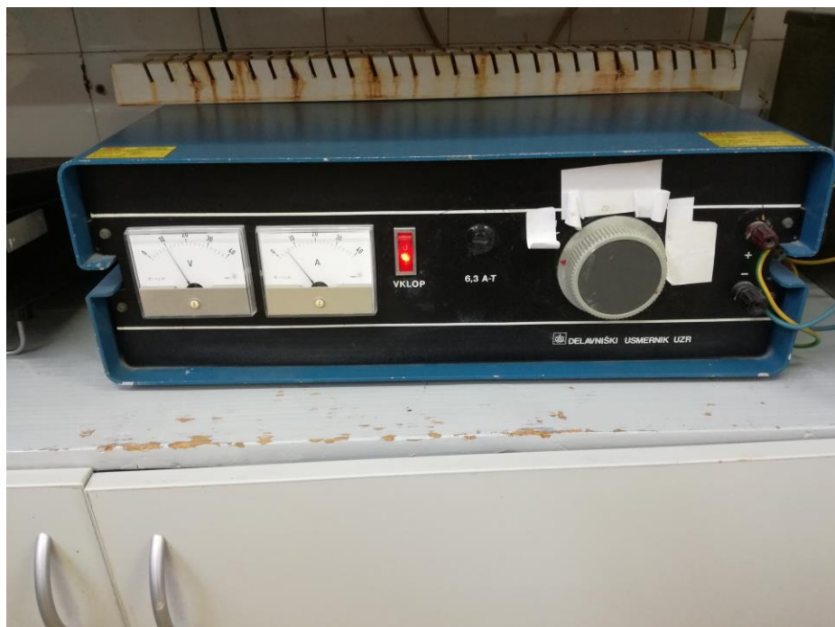
Slika 23. Uređaj za podešavanje parametara struje nagrivanja
