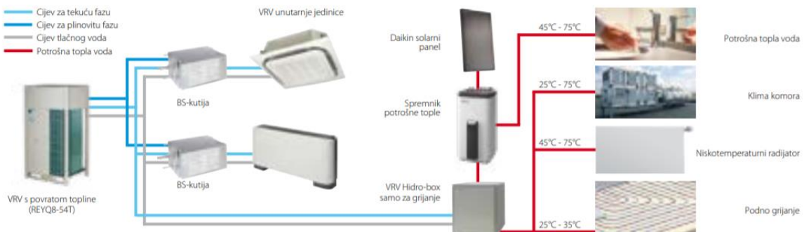
Slika 15: VRV IV sustav s povratom topline
