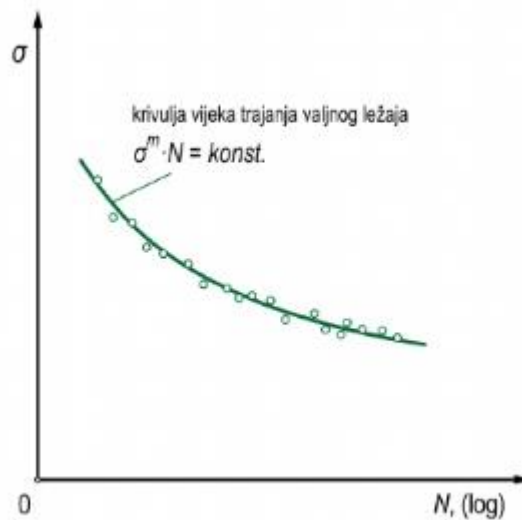
Slika 7. Krivulja vijeka trajanja valjnog ležaja [2]
