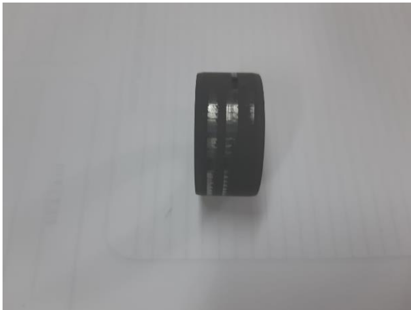
Slika 17. Izgled traga trošenja nastalog metodom prizma na prsten
