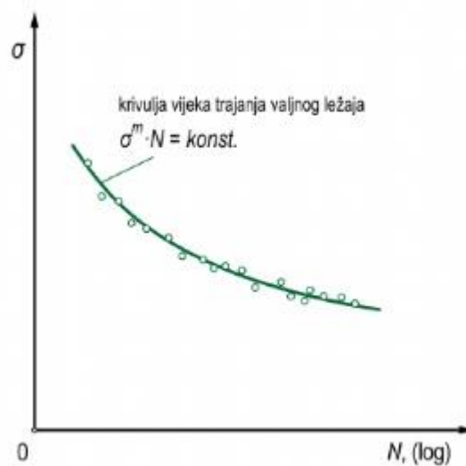
Slika 7. Krivulja vijeka trajanja valjnog ležaja [2]
