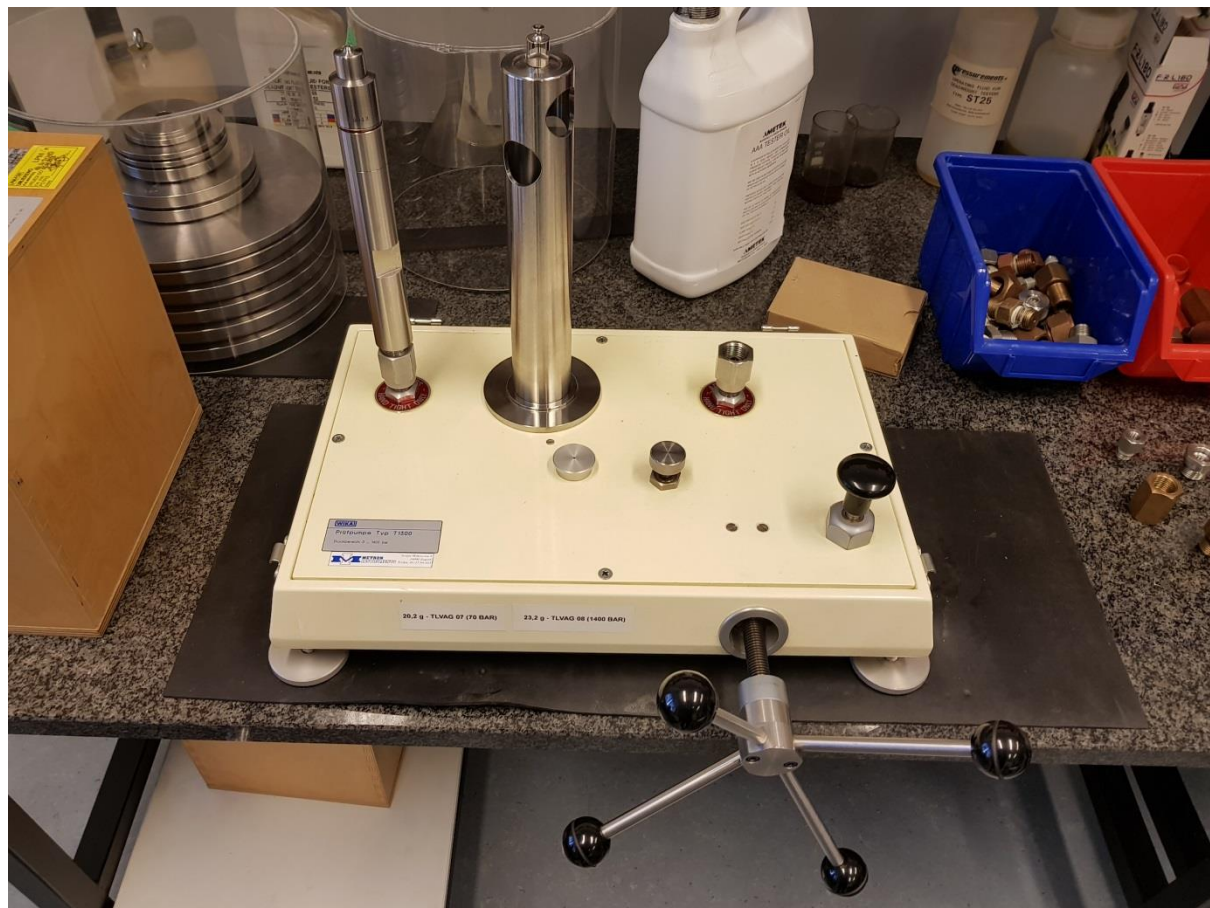
Slika 5. Tlačna vaga WIKA T1300
