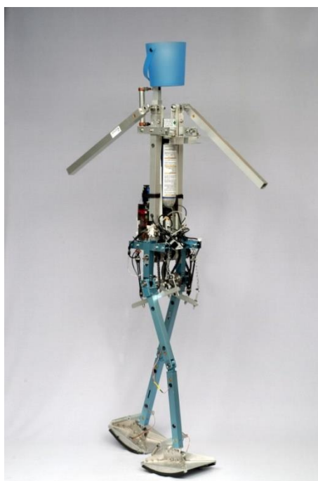
Slika 11. Pneumatski humanoidni robot Denise sveučilišta TUDelft
