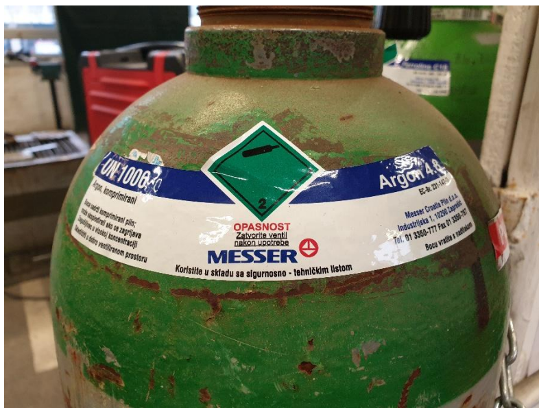
Slika 9. Boca sa zaštitnim plinom (Ar)
