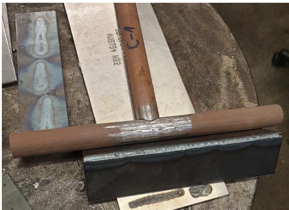
Slika 13. Pripremljene cijevi za zavarivanje kutnog spoja
