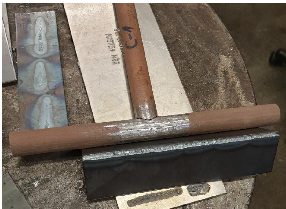
Slika 13. Pripremljene cijevi za zavarivanje kutnog spoja
