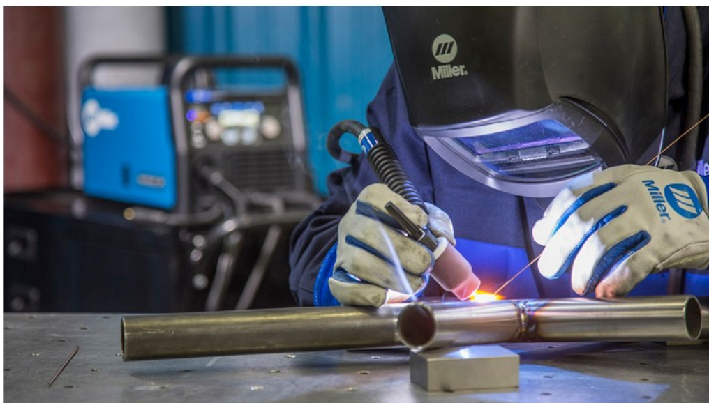
Slika 17. TIG postupak zavarivanja [20]
