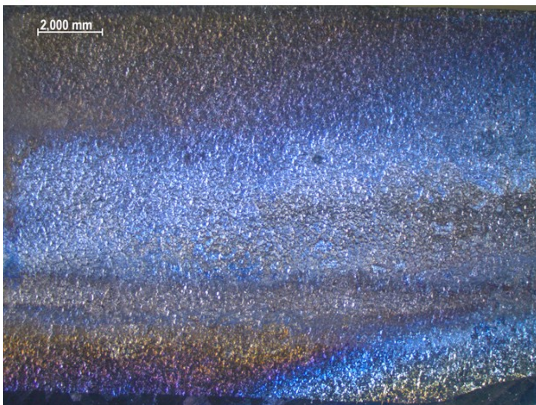
Slika 32. Izgled površine ZUT-a na desnoj strani uzorka A2. (a) Prije ispitivanja. (b) Poslije ispitivanja.
