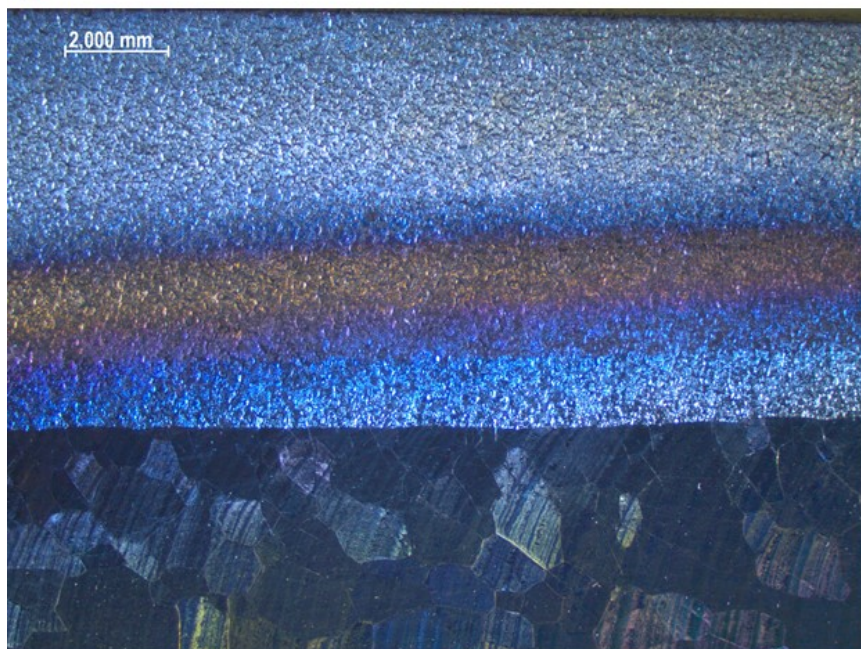
Slika 35. Izgled površine ZUT-a na sredini uzroka B2. (a) Prije ispitivanja. (b) Poslije ispitivanja.
