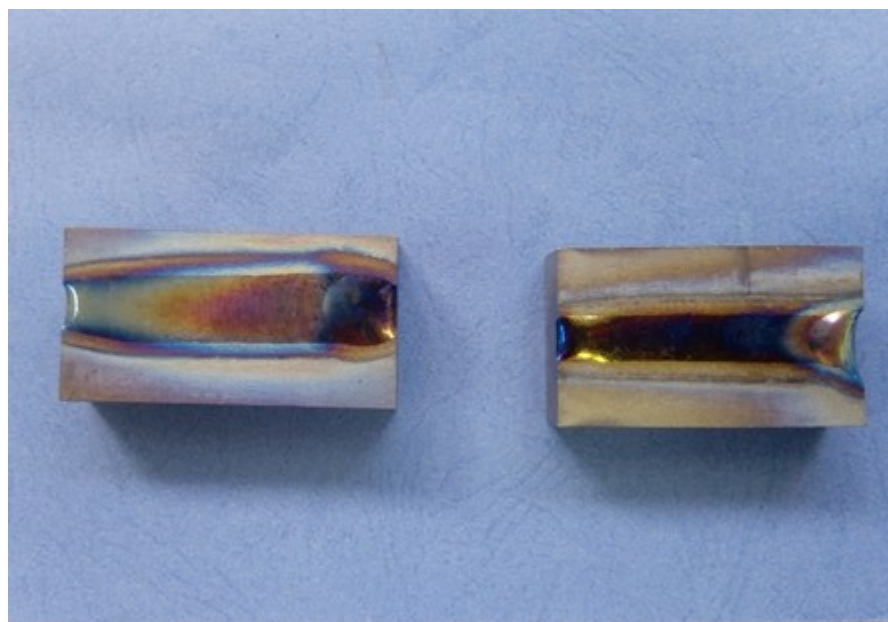
Slika 29. Uzorci nakon ispitivanja u ključajućoj otopini natrijeva klorida
