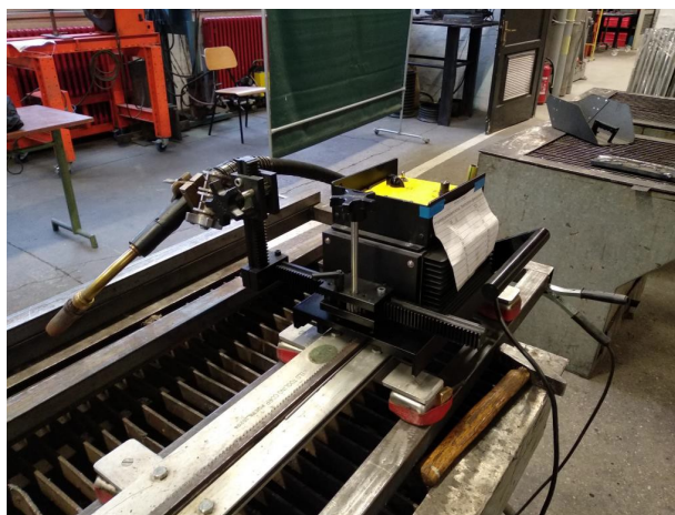
Slika 25. „BUGO Systems“ sustav za mehanizaciju postupka zavarivanja [2].
