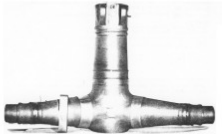
Slika 13. Greda podvozja zrakoplova IL76 napravljena od Ti-2.5Al-5V-5Mo-1.3Cr-1Fe legure [9]
