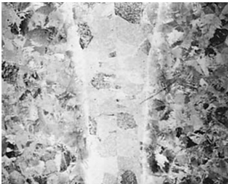
Slika 8. Makrografski prikaz veličine grubih beta zrna u zavaru elektronskog snopa Ti-6Al-4V legure [1].
