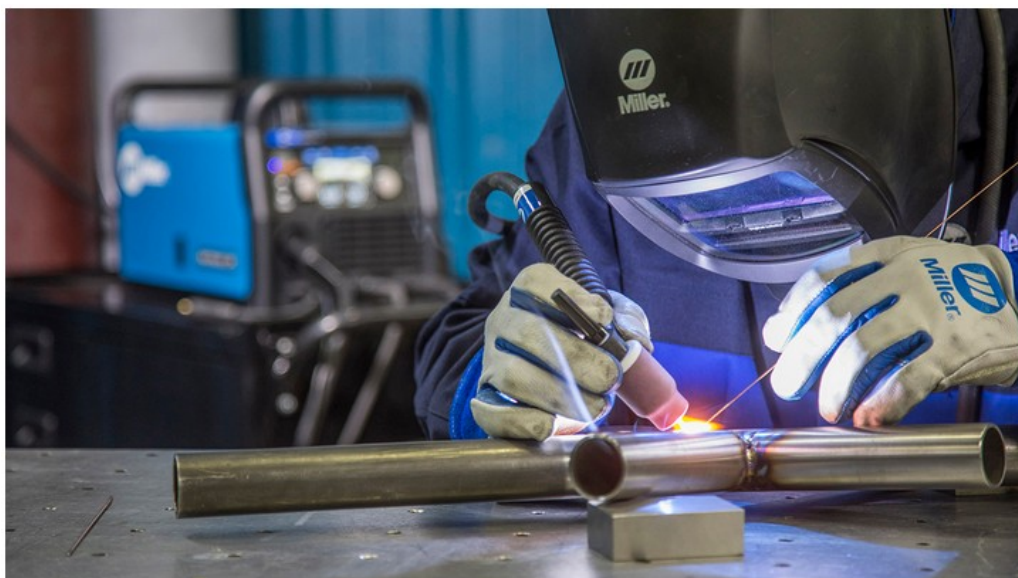
Slika 17. TIG postupak zavarivanja [20]
