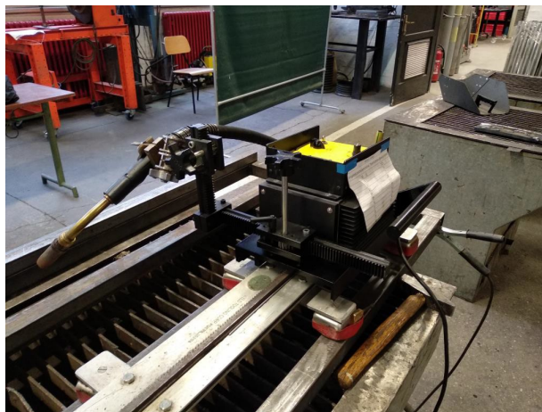
Slika 25. „BUGO Systems“ sustav za mehanizaciju postupka zavarivanja [2].
