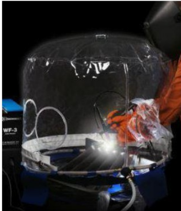
Slika 11. Izvođenje postupka zavarivanja u komori za zavarivanje [12]
