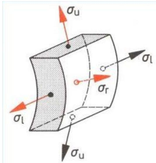
Slika 31. Prikaz naprezanja unutar posude pod tlakom [5]
