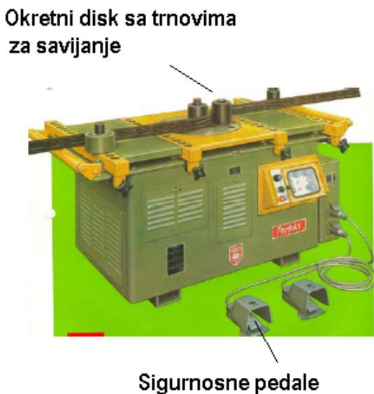
Slika 3.2 Stroj za savijanje čeličnih šipki
