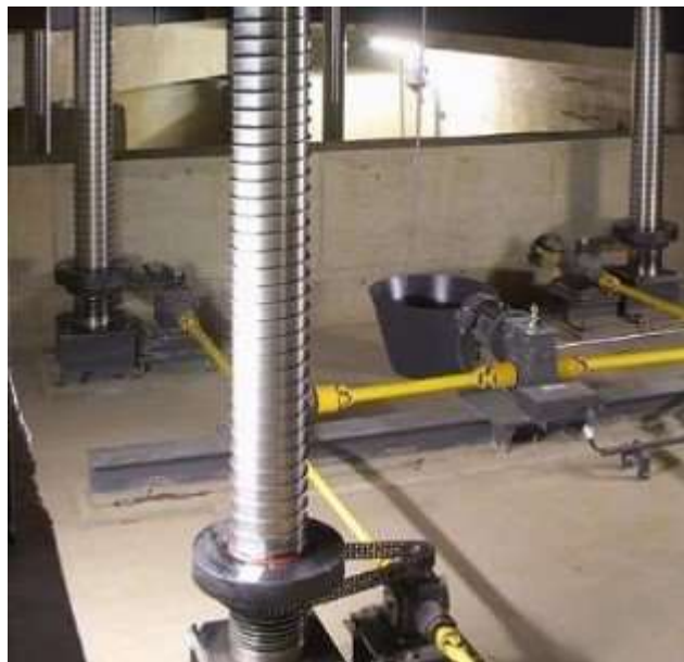
Slika 11. Primjena navojnog vretena
