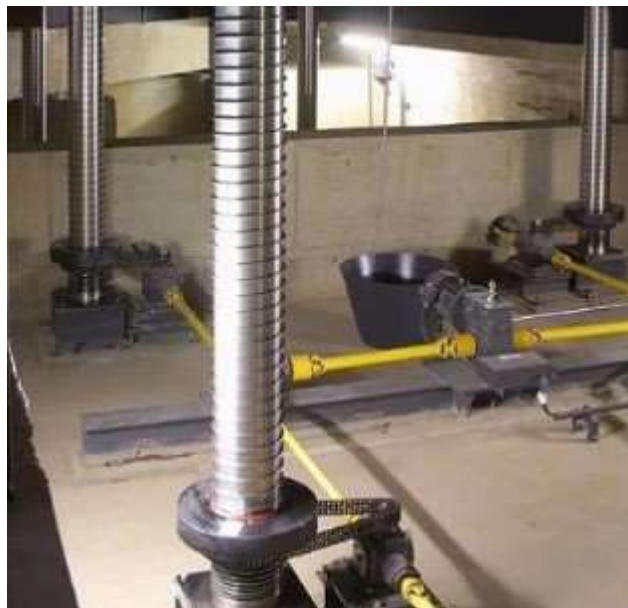
Slika 11. Primjena navojnog vretena
