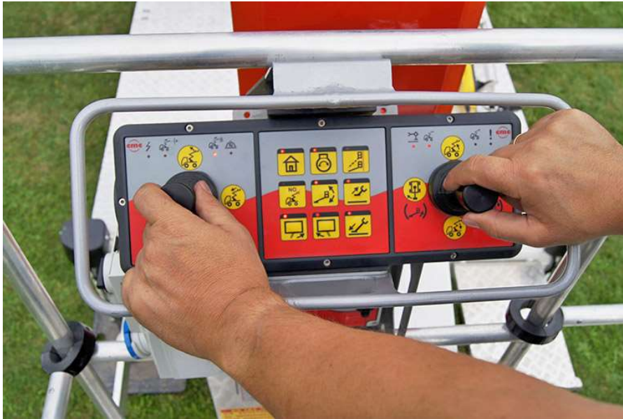
Slika 20. Upravljačka ploča na košari
