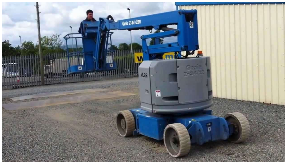
Slika 13. Genie Z34/22N pogonjen sustavom baterija
