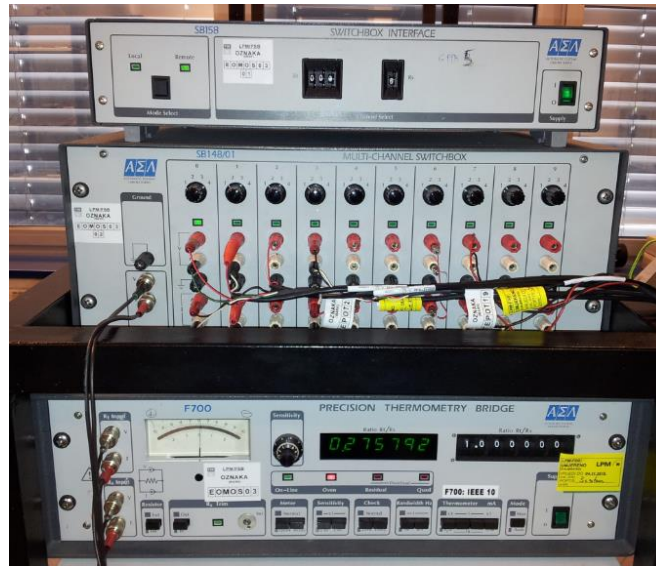
Slika 9. Termometrijski otpornički most sa svim spojenim komponentama
