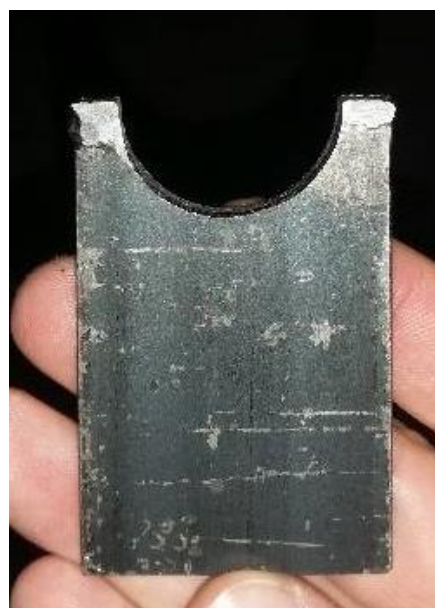
Slika 24. Čelična pločica s utorom za objumicu
