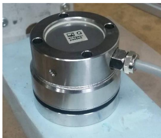
Slika 18. Vlačno-tlačni osjetnik sile HBM U3 0,5 kN
