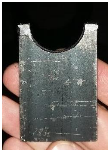
Slika 24. Čelična pločica s utorom za objumicu
