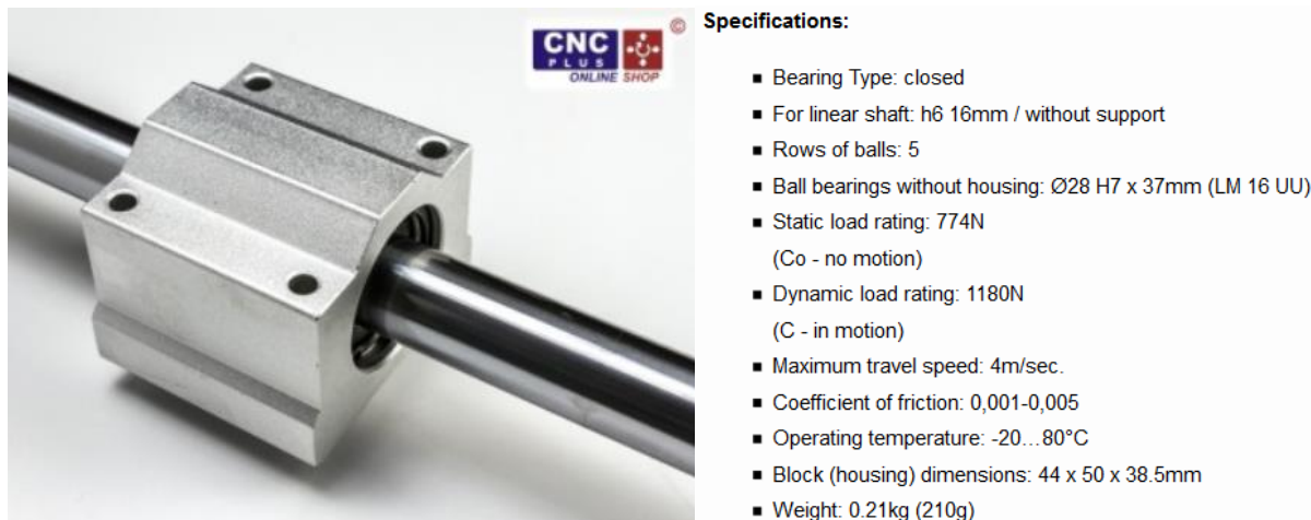
Slika 39. Linearni ležaj i specifikacije tvrtke "CNC plus"[18]
