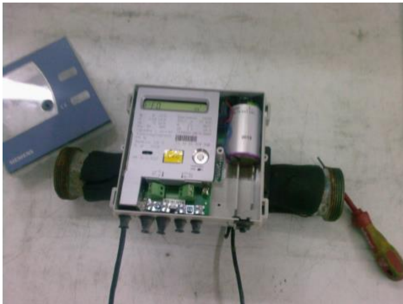
Slika 20. Postupak ispitivanja računске jedinice
