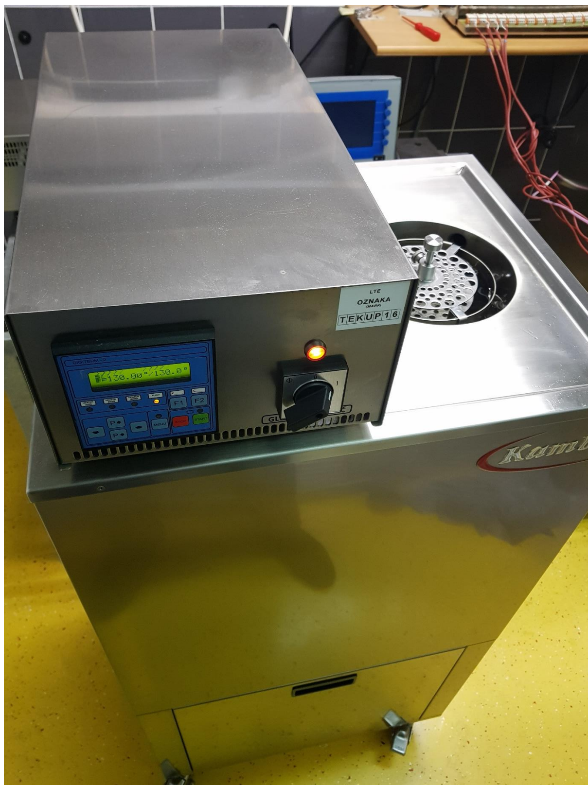
Slika 18. Temperaturna kupka (130 °C)
