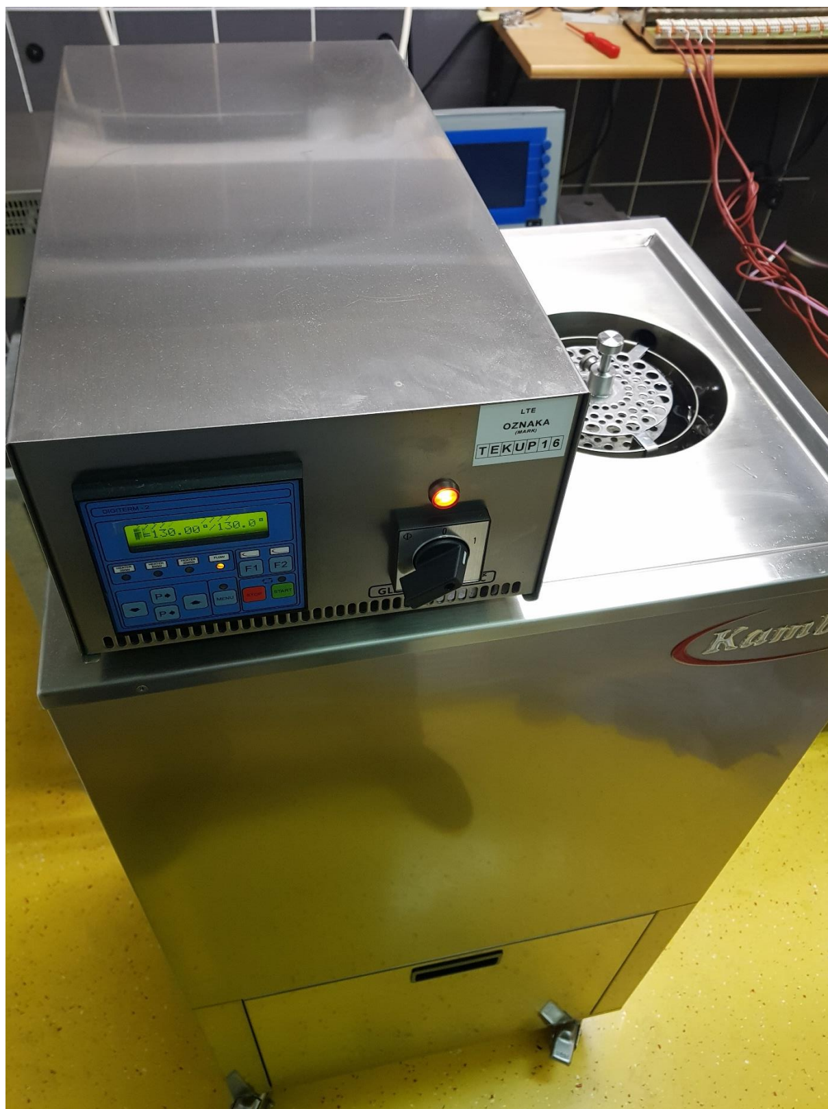
Slika 18. Temperaturna kupka (130 °C)
