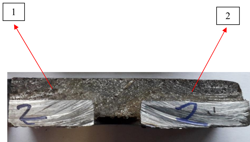
Slika 41. Lokacije analize kemijskog sastava kočione obloge 2
