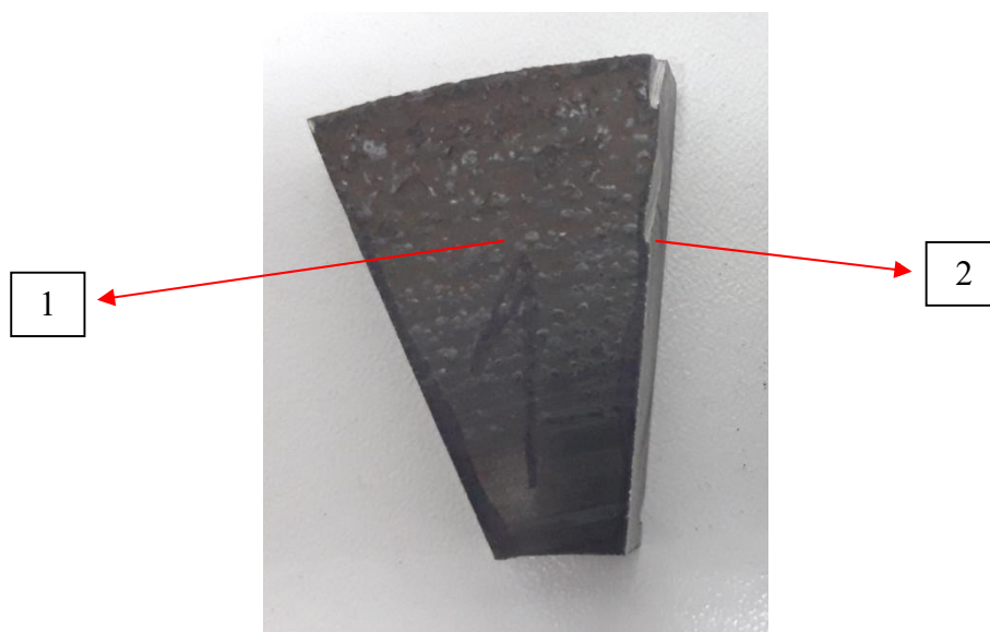
Slika 38. Lokacije analize kemijskog sastava kočionog diska 1
