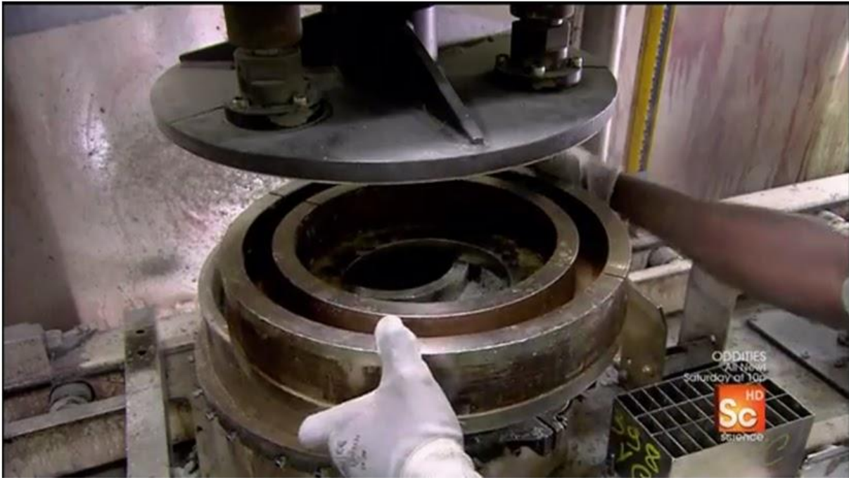
Slika 11. Izrada keramičkih diskova u kalupima [8]
