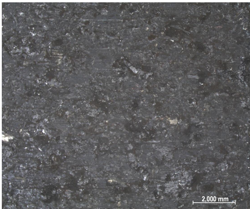
Slika 81. Snimak tragova trošenja kočione obloge 1 pri povećanju od 10x
