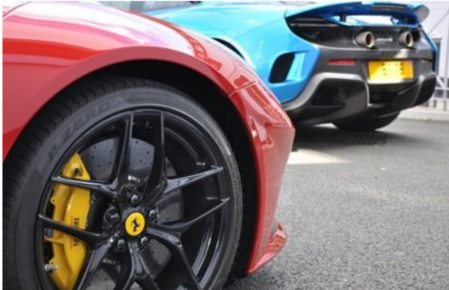
Slika 12. Keramički diskovi u primjeni kod brzih automobila marke Ferrari [8]
