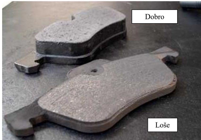
Slika 15. Primjer nove i potrošene disk pločice
