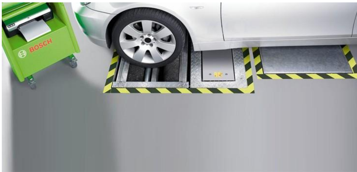
Slika 2. Ispitivanje kočnica na valjcima za tehnički pregled [4]
