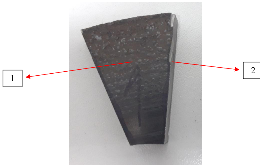
Slika 38. Lokacije analize kemijskog sastava kočionog diska 1
