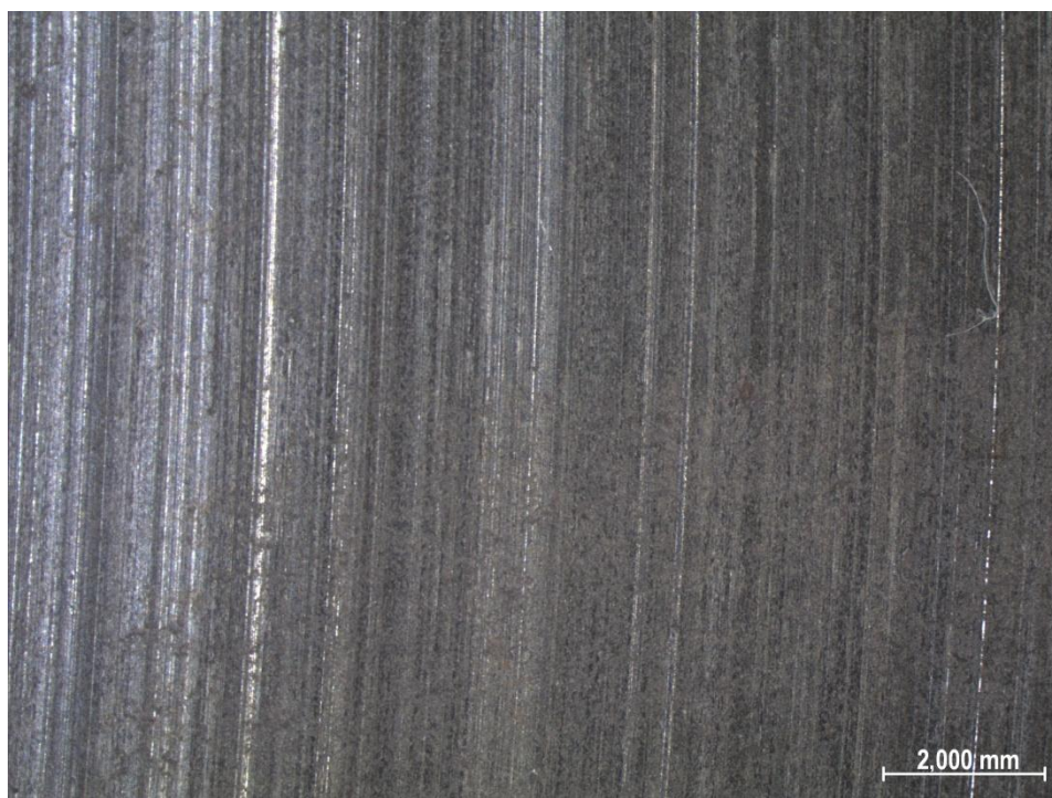
Slika 78. Snimak tragova trošenja kočionog diska 2 pri povećanju od 10x
