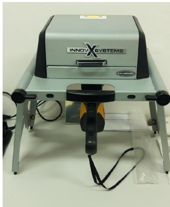
Slika 37. XRF analizator kemijskog sastava proizvođača Innov-X Systems
