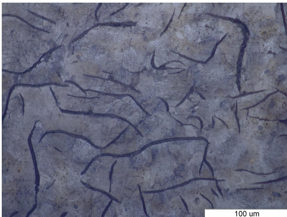
Slika 67. Mikrostruktura nagrižene površine kočionog diska 1 pri povećanju od 500x
