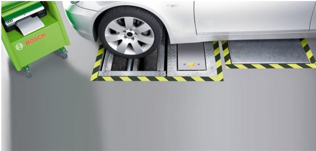
Slika 2. Ispitivanje kočnica na valjcima za tehnički pregled [4]
