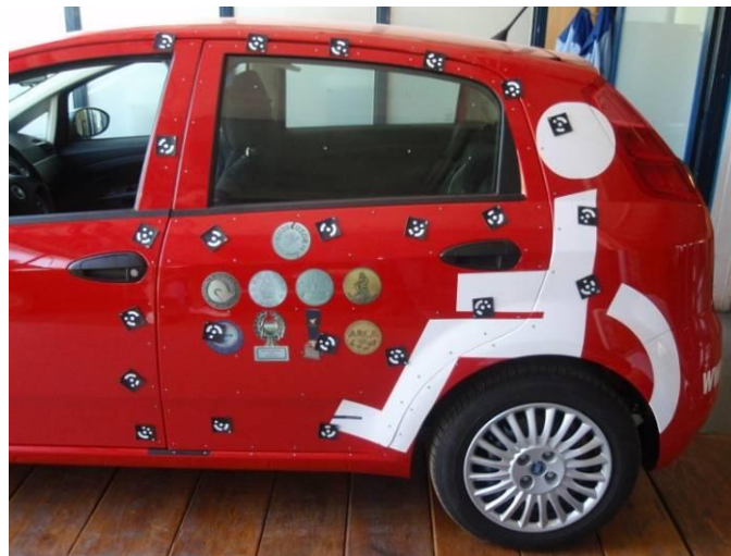
Slika 7. Postavljanje mjernih točaka (kodiranih i nekodiranih)
