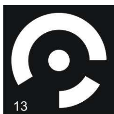
Slika 3. Kodirana kontrolna točka
