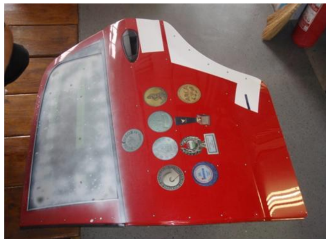
Slika 8. Postavljanje nekodiranih mjernih točaka na vratima
