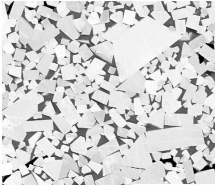
Slika 5. Mikrostruktura tvrdog metala WC/Co [5]
