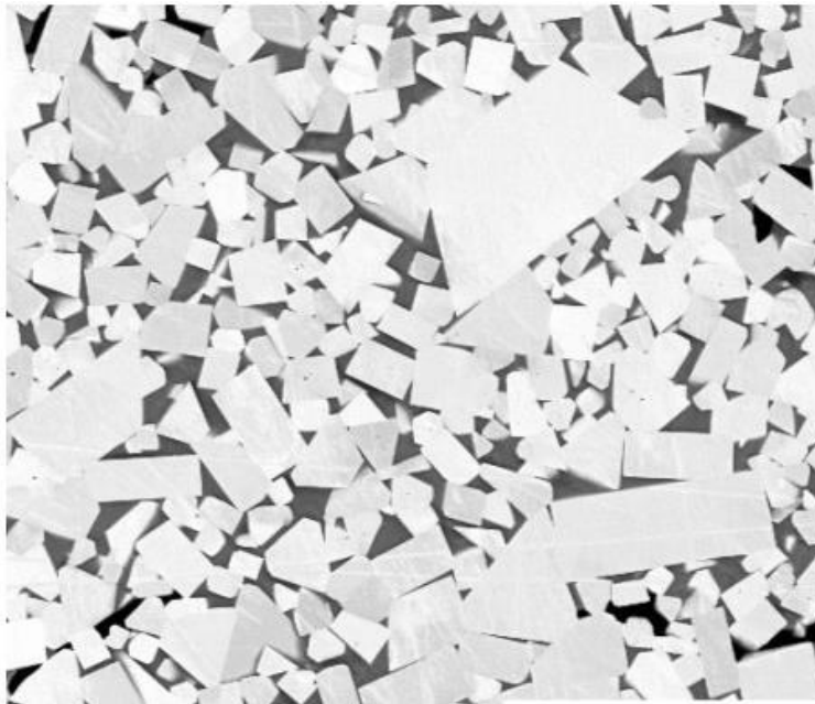
Slika 5. Mikrostruktura tvrdog metala WC/Co [5]
