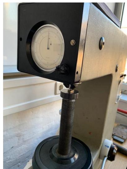
Slika 13. Uređaj za mjerjenje tvrdoće po Rockwellu
