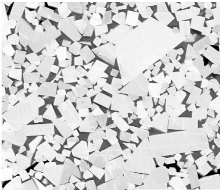
Slika 5. Mikrostruktura tvrdog metala WC/Co [5]
