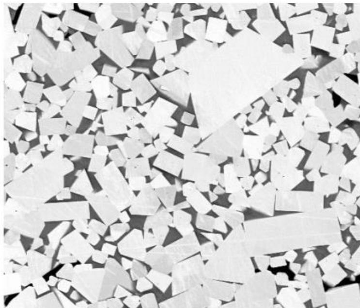
Slika 5. Mikrostruktura tvrdog metala WC/Co [5]
