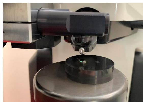
Slika 21. Postupak mjerena tvrdoće
