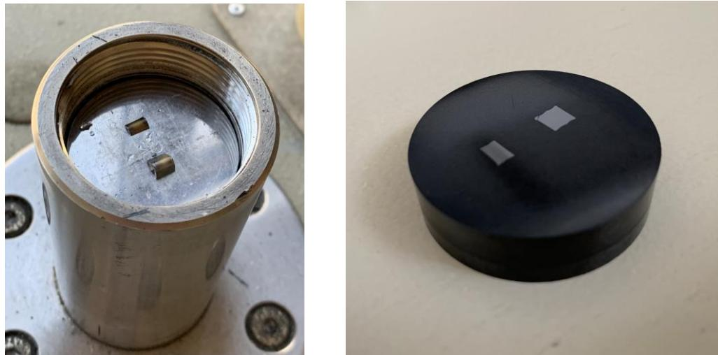
**Slika 16. Zalijevanje uzorka u polimernu masu**
