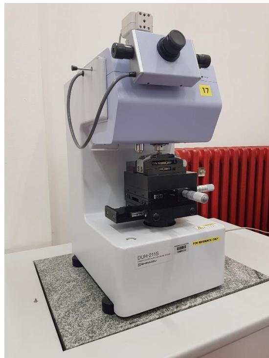
Slika 18. Tvrdomjer DUH-211 proizvođača Shimatzu, Japan
