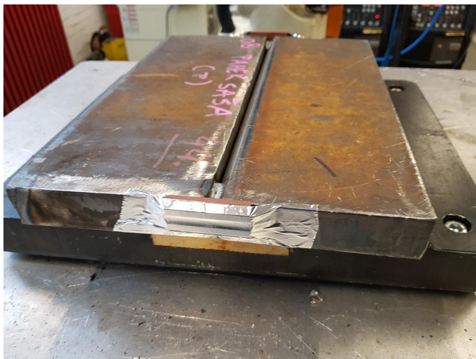
Slika 5.8 Pripremljen uzorak (2) sa krajnjim pločicama
