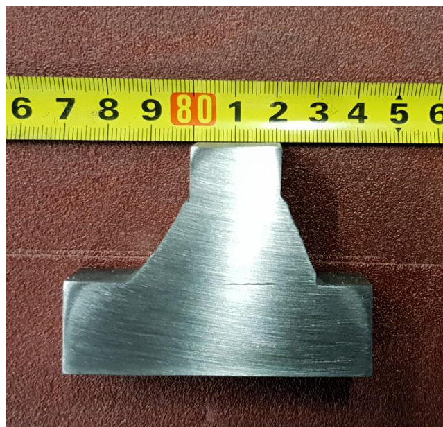
Slika 5.18 Makroizbrusak nakon operacije ručnog brušenja
