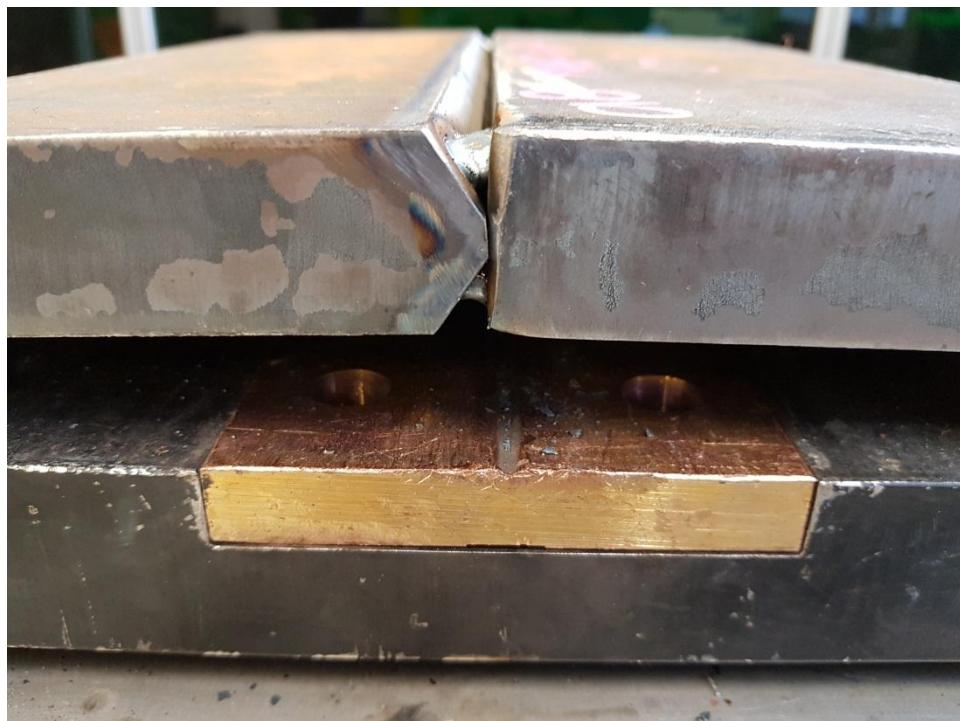
**Slika 5.7      Pripremljen uzorak (2) bez krajnjih pločica**
