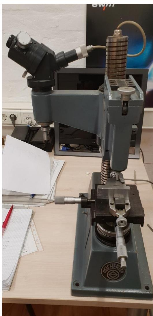
Slika 5.24 Tvrdomjer Reicherter TM12
