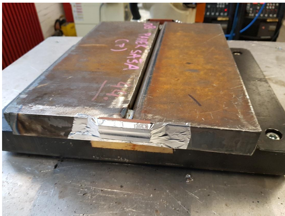
Slika 5.8 Pripremljen uzorak (2) sa krajnjim pločicama
