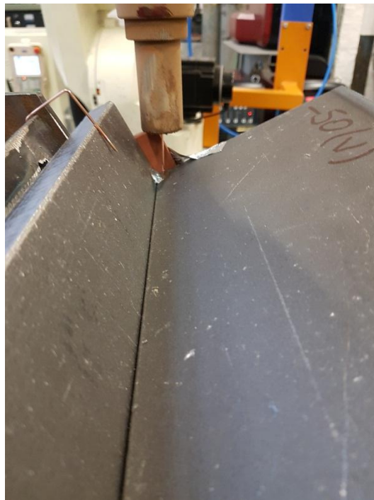
Slika 5.6 Uzorak (1) pozicioniran na stolu za zavarivanje
