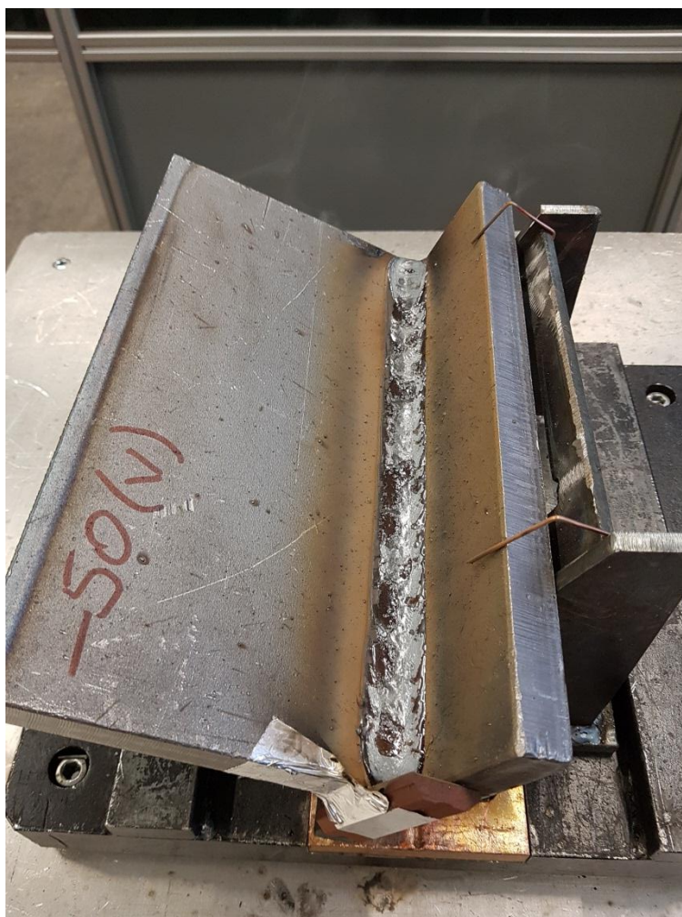
Slika 5.12 Uzorak (1) nakon zavarivanja
