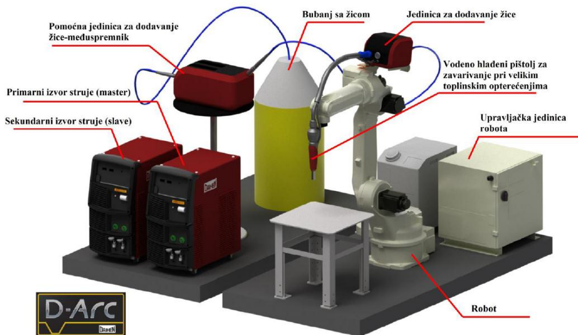
Slika 4.13 D-arc sustav za zavarivanje zakopanim lukom [5]
