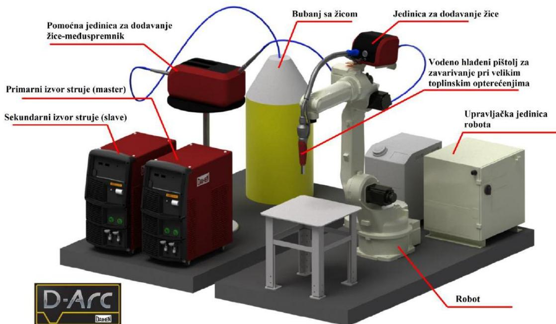
Slika 4.13 D-arc sustav za zavarivanje zakopanim lukom [5]
