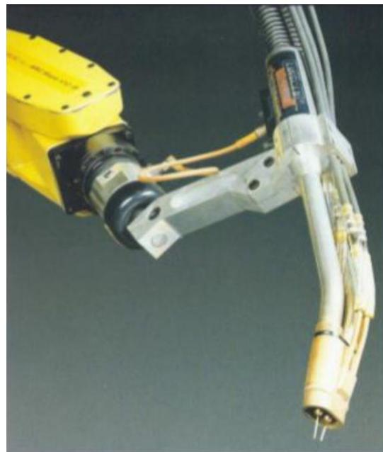
**Slika 3.7 Pištolj za tandem postupak zavarivanja [8]**
