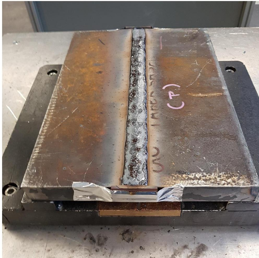
**Slika 5.15 Uzorak (2) nakon zavarivanja**
