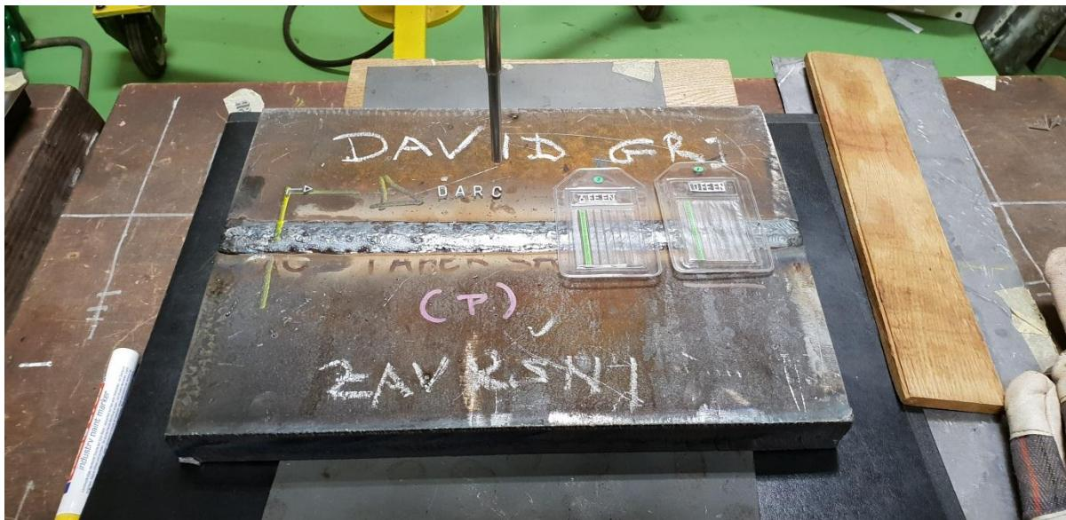
Slika 5.27 Pripremljeni komad za radiografsko ispitivanje
