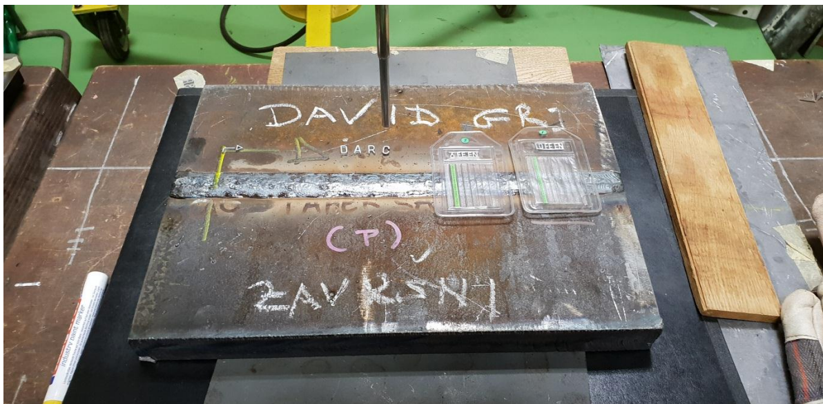
Slika 5.27 Pripremljeni komad za radiografsko ispitivanje
