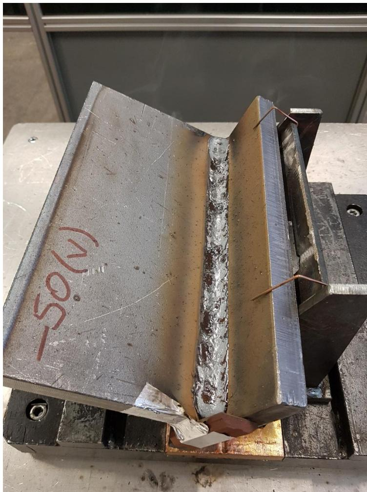
**Slika 5.12      Uzorak (1) nakon zavarivanja**
