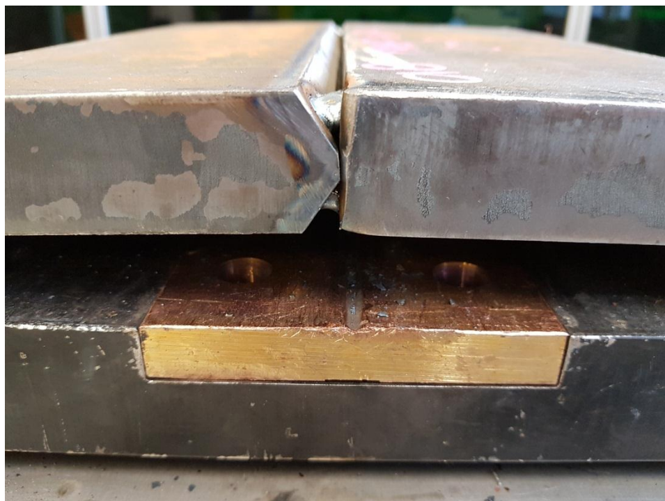
Slika 5.7 Pripremljen uzorak (2) bez krajnjih pločica
