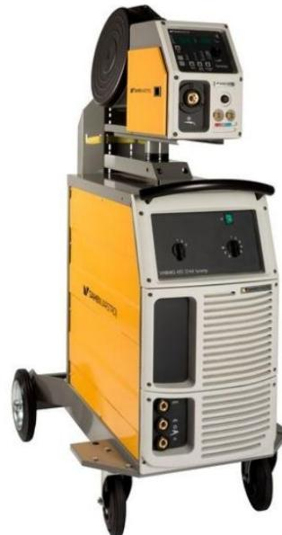
**Slika 2.9 Izvor struje za MAG zavarivanje (Daihen-Varstroj) [6]**
