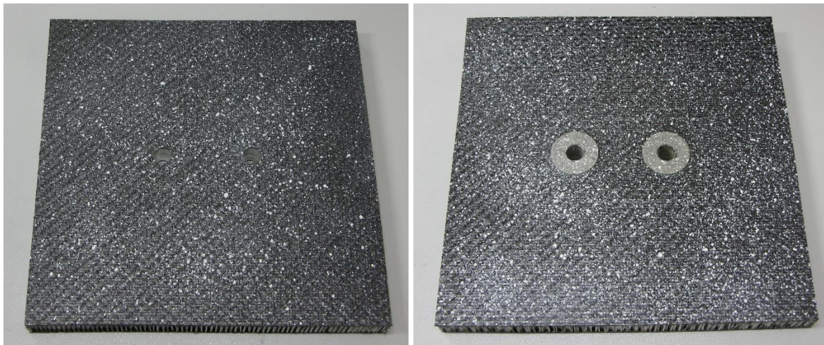
Slika 48. Uzorci nakon nanošenja stohastičkog rastera
