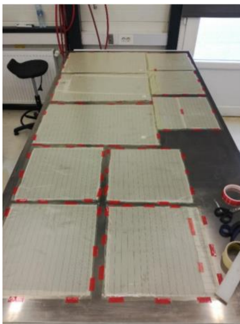
Slika 32. Postavljanje odjeljivača prije prvog umrežavanja
