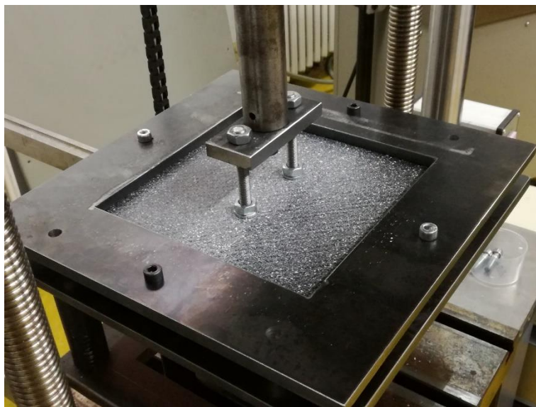
Slika 47. Ispitivanje uzoraka na vlak
