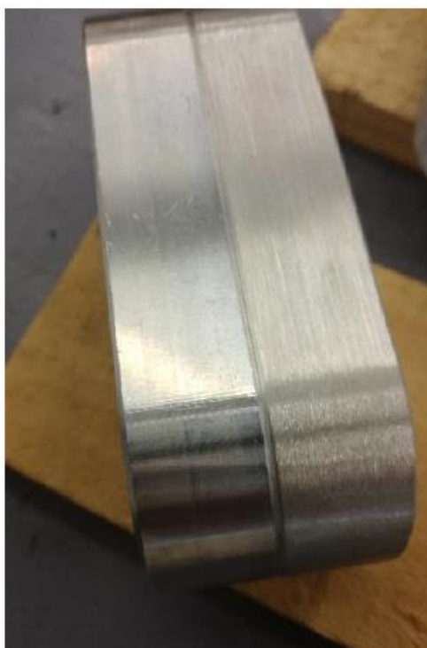
Slika 37. Obradena i neobradena površina umetka
