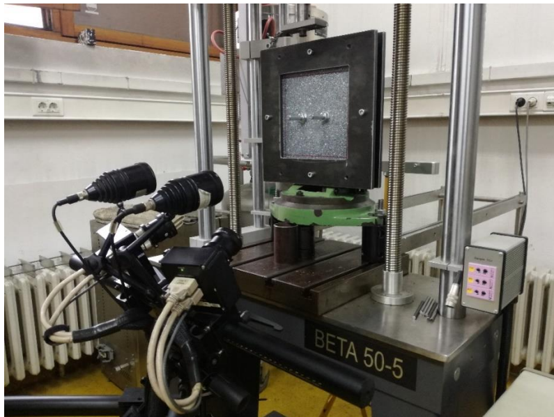
Slika 56. Eksperimentalni postav kod ispitivanja uzoraka pri savijanju
