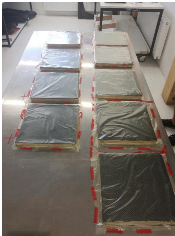
Slika 39. Postavljanje release filma prije drugog umrežavanja
