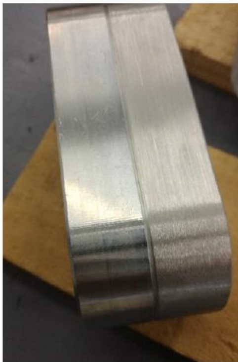
Slika 37. Obradena i neobradena površina umetka
