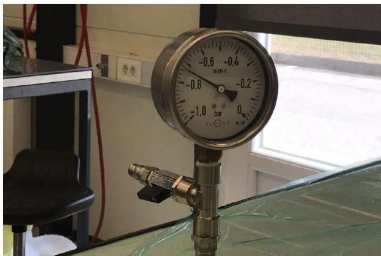
Slika 35. Mjerenje tlaka unutar vakuum vreće
