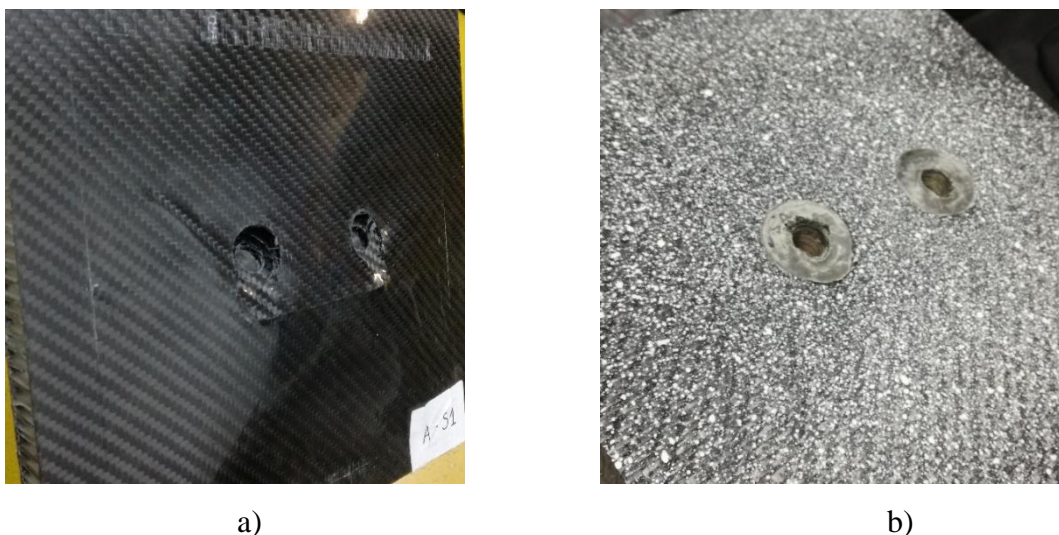
Slika 71. Oštećenje na uzorcima nakon opterećenja na savijanje: a) uzorak A-S1 i b) uzorak C-S2
