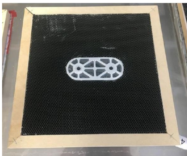
Slika 36. Pozicionirani umetak unutar sendviča
