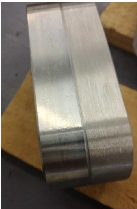
Slika 37. Obradena i neobrađena površina umetka
