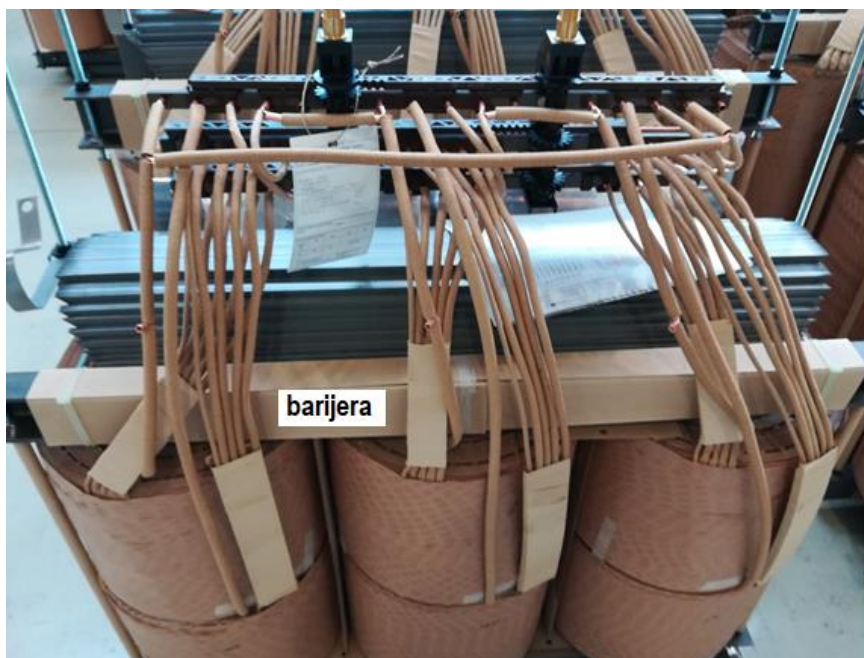
Slika 25. Montirana barijera na metalni steznik DT-a
