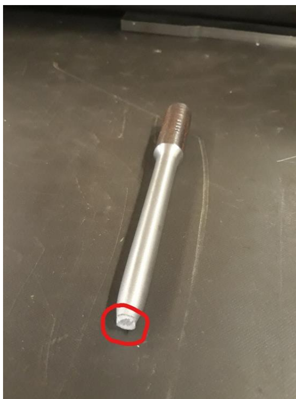
Slika 4.11. Mjesto mjerenja temperature nakon loma
