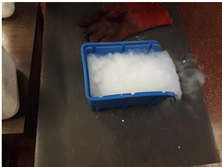
Slika 4.7. Ohlađivanje pomoću suhog leda i alkohola
