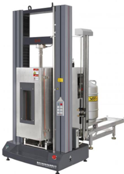
Slika 3.2. Komora za ohlađivanje montirana na kidalicu
