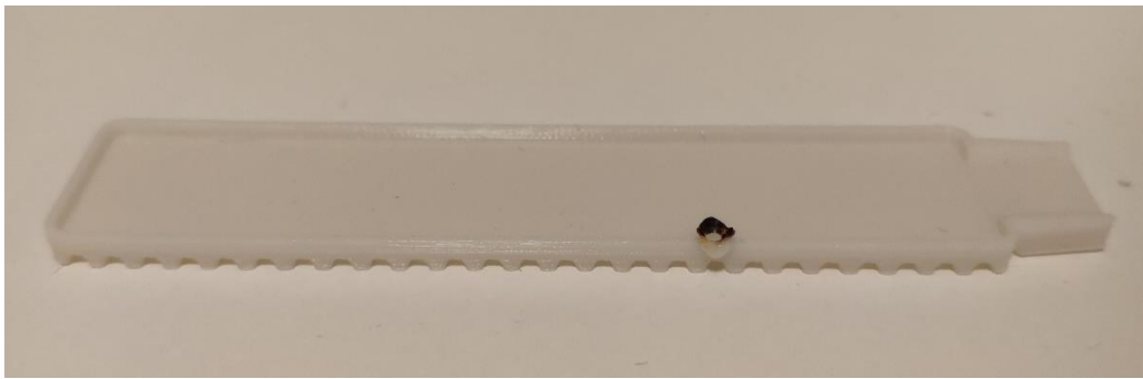
Slika 39. Greška u printeru nastala pregrijavanjem mlaznice
