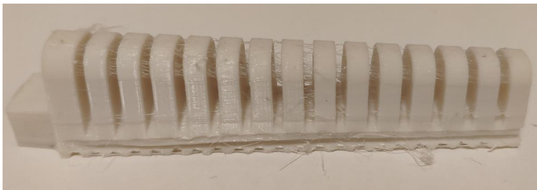
Slika 37. Greška na kraku nastala preskakanjem slojeva
