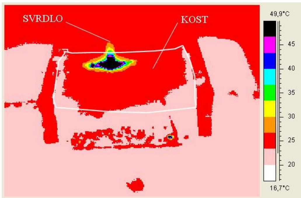
Slika 6. Termografski prikaz porasta temperature tijekom bušenja kosti [1]
