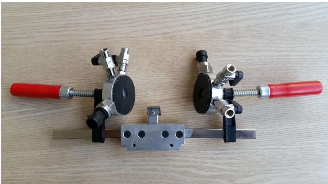
Slika 23. Stezna naprava za prihvatanje koštanih uzoraka [15]
