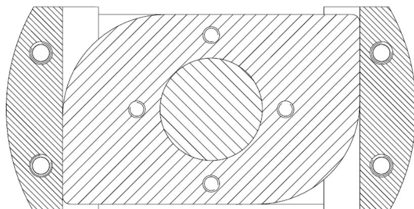
Slika 28. Način spajanja robotskog modula u čeljust robotskog sustava
