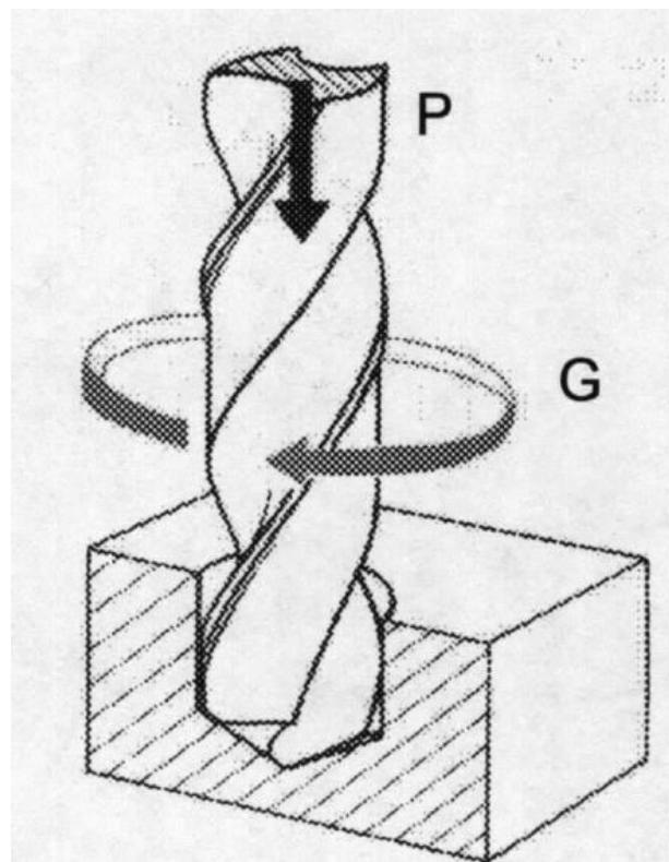
Slika 1. Prikaz gibanja alata kod izrade provrta [2]
