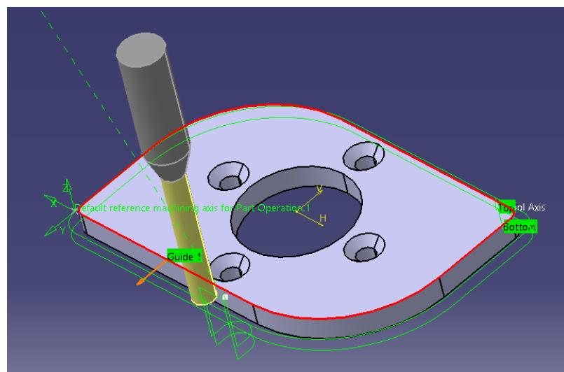
Slika 31. Konturiranje spojne ploče modula robotskog sustava
