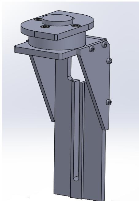
Slika 24. 3D model modula robotskog sustava
