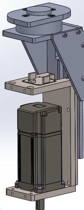
Slika 25. Cjelokupni sklop modula s motorvretenom
