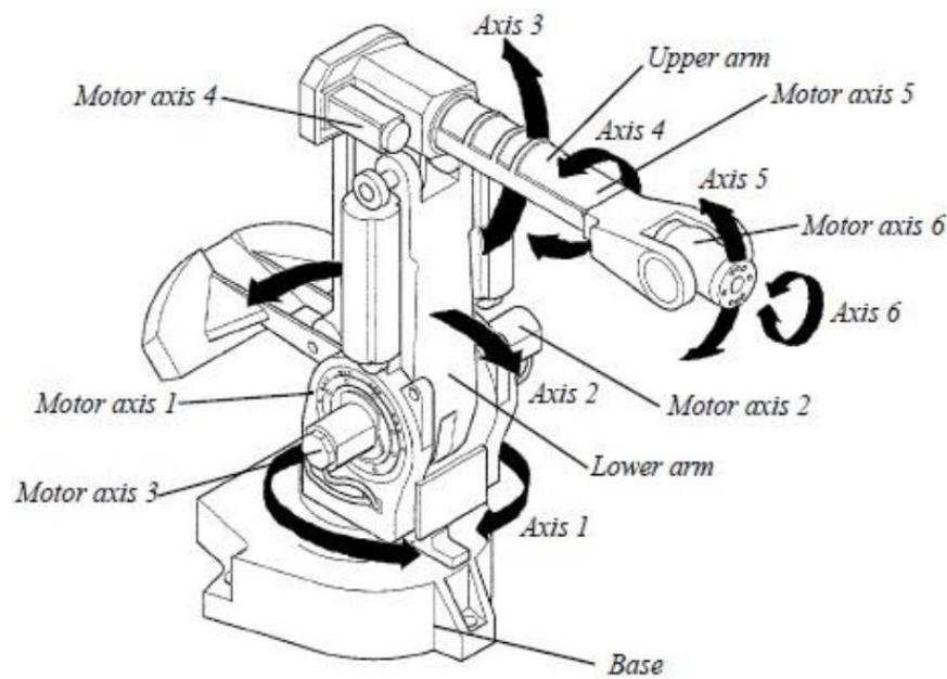
Slika 14. Struktura robota ABB IRB 6400 [13]
