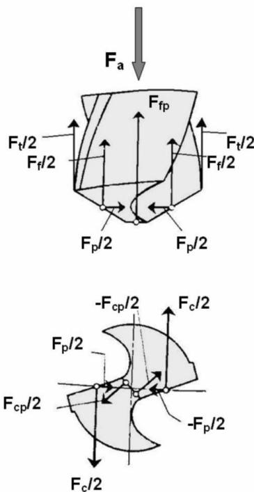
Slika 4. Sile rezanja kod bušenja [3]
