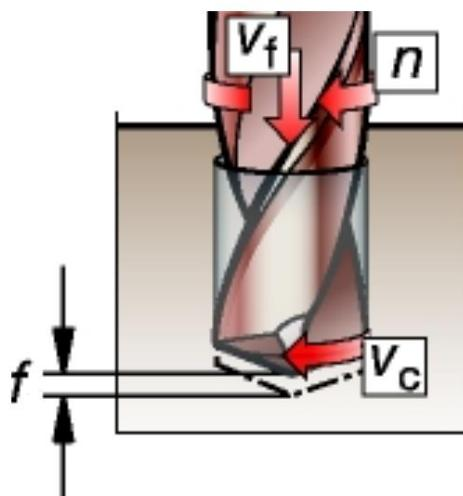
Slika 3. Prikaz parametara obrade kod izrade prvorta [4]
