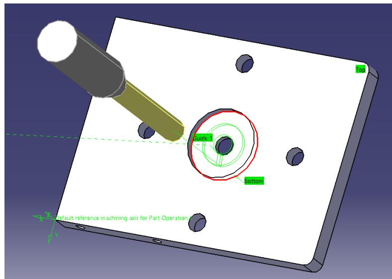
Slika 30. Izrada đepa horizontalne ploče modula robotskog sustava
