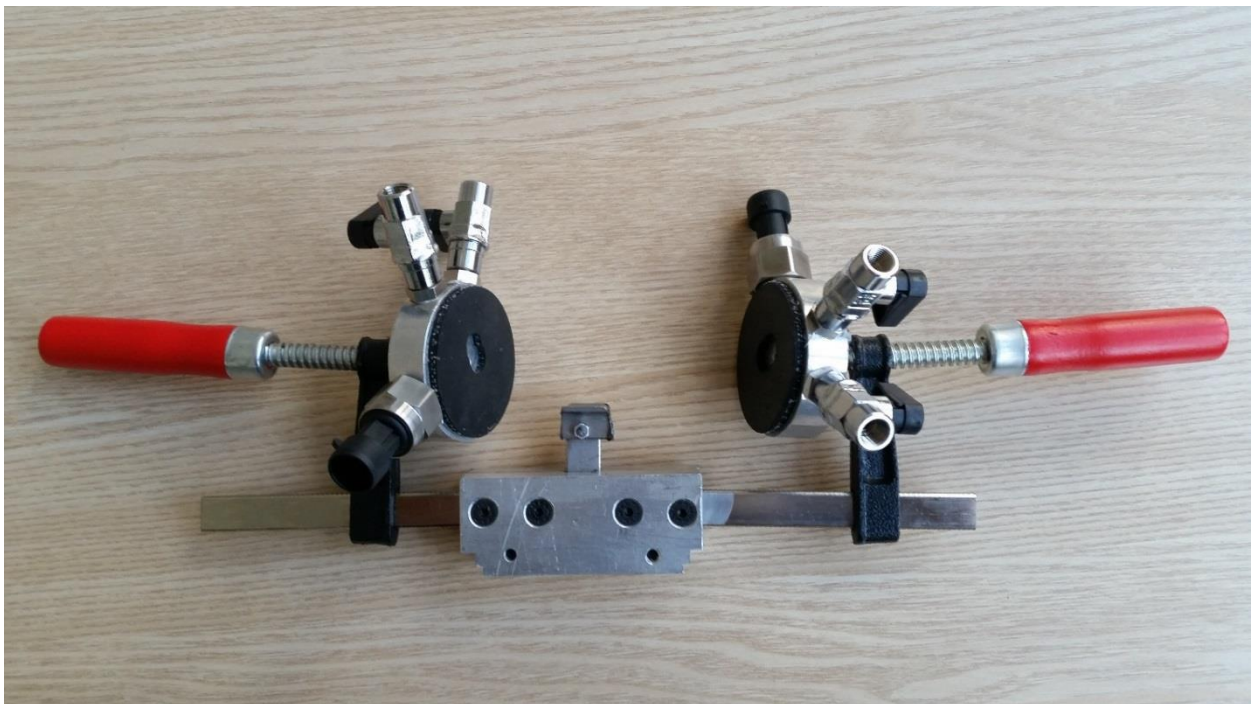
Slika 23. Stezna naprava za prihvat koštanih uzoraka [15]
